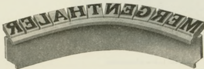
5. ábra. Egy Ludlow-öntőgépen előállított sor háromcicerós törzssel meghajlítva, amit a sor egy cicerós talpa igen könnyen lehetővé tesz.
