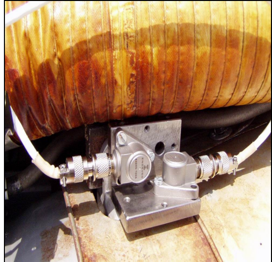
16.ábra: A kompresszoron és a turbinán elhelyezett szenzorok
