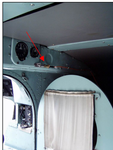
11.ábra: Műszerfalon és a fülkeajtón lévő érzékelők
