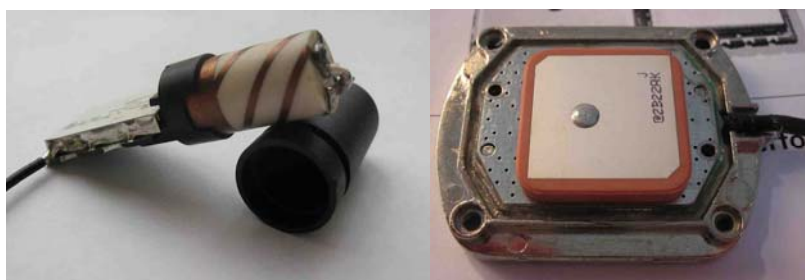
3. ábra. Aktív QFHA és Patch antenna
