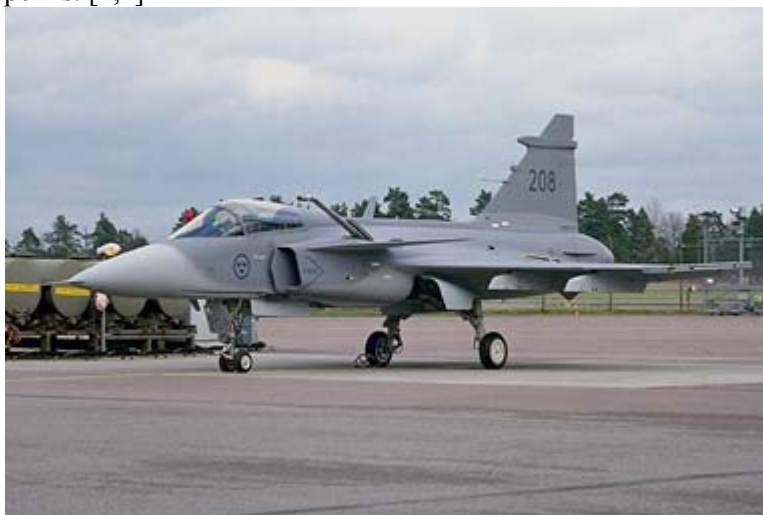
1. ábra. Az üzemanyag utántöltő teleszkópikus cső kiengedett helyzetében
