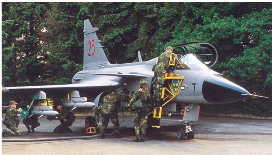
2. ábra. A repülőgép ismételt feladatra történő előkészítése tábori körülmények között.
