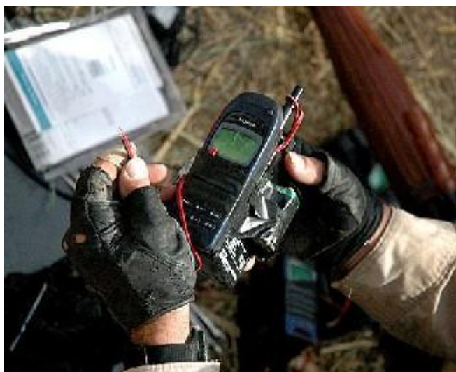
3. kép. Mobil telefon, mint a robbantást vezérlő eszköz [2]
