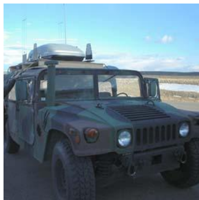
5. – 6. kép. Bombazavaró gépjárművek polgári és katonai kivitelben [4]
