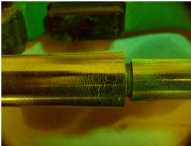
9. ábra etalon a mágneses roncsolásmentes anyagvizsgálat érzékenységének megállapításához
