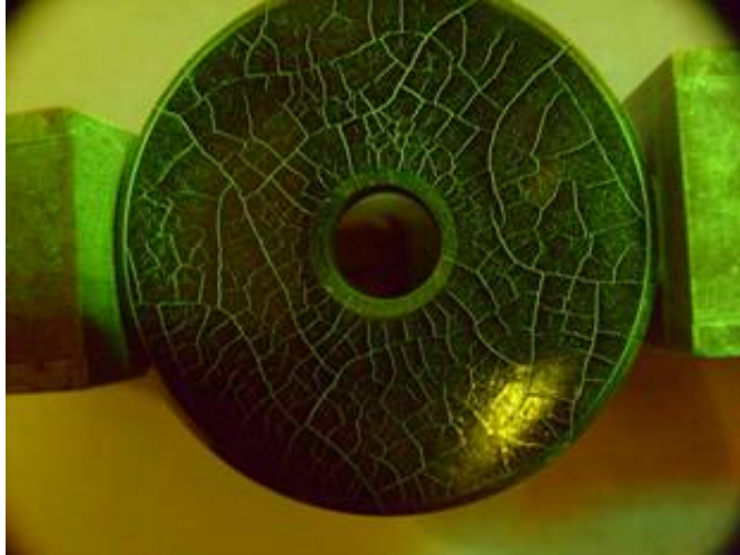
8. ábra etalon a mágneses roncsolásmentes anyagvizsgálat érzékenységének megállapításához [8] (EN ISO 9934-2:2002 E)
