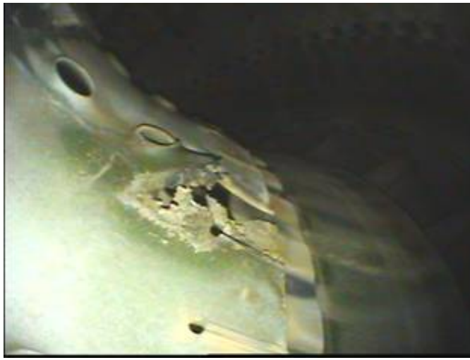
5. ábra endoszkóppal készült felvétel, égőtér kiolvadás
