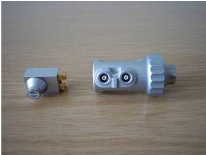
13. ábra, különböző alkatrész vizsgálatokhoz alkalmazható vizsgálófejek
