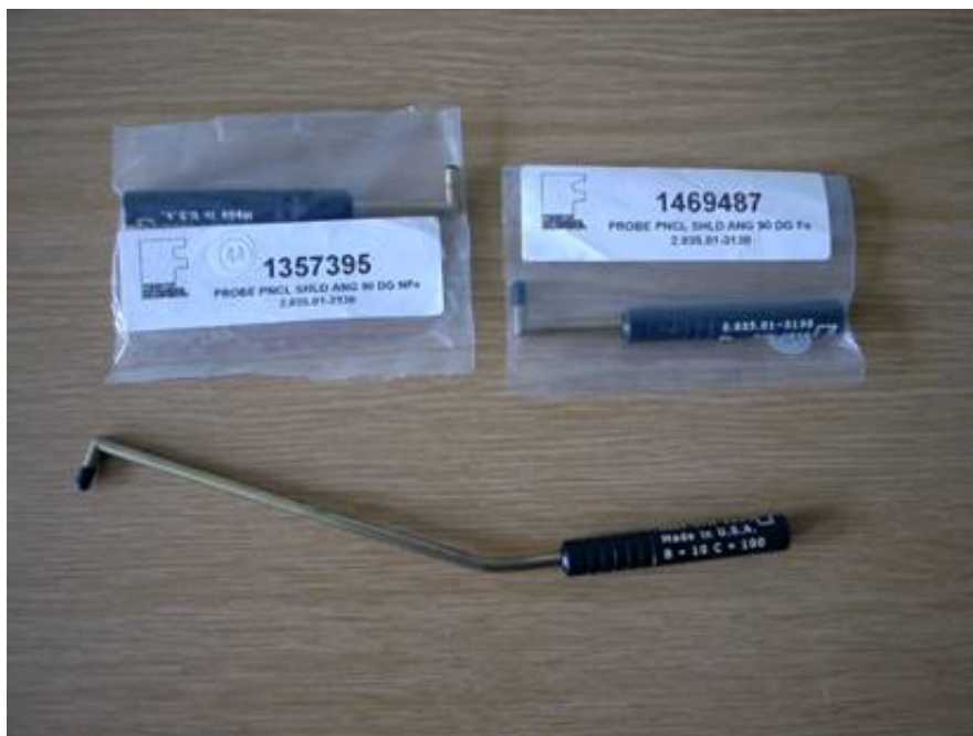
12. ábra különböző anyagból készült alkatrészek vizsgálatához alkalmazható szondák
