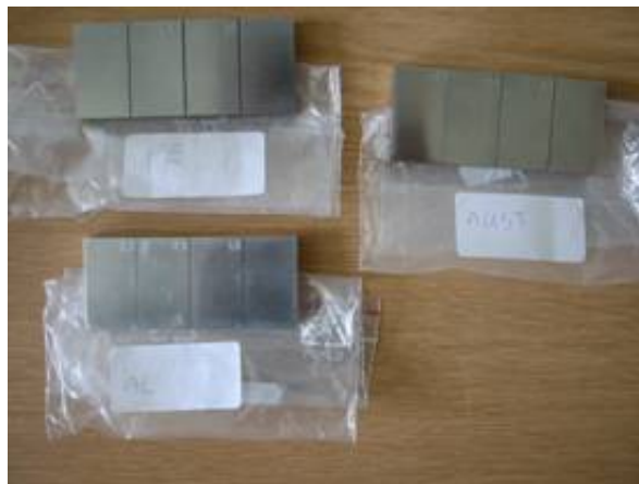
11. ábra etalonok különböző anyagból készült alkatrészek hibaméret meghatározásához
