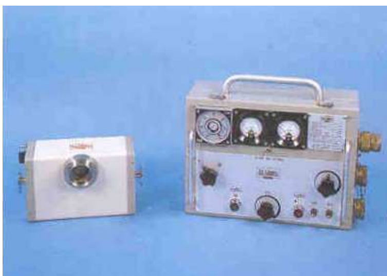
4. ábra. Gilardoni Radiolight típusú röntgen generátor fényképe
