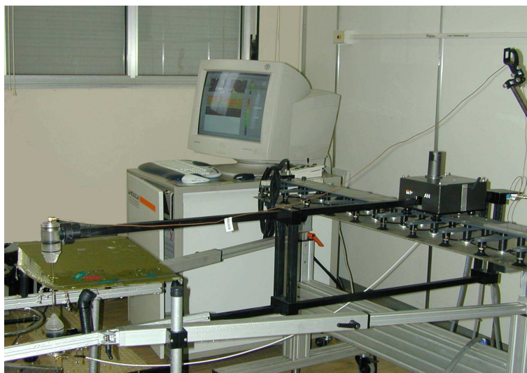
6. ábra. A Metalscan Galaxy típusú Ultrahang vizsgáló berendezés fényképe
