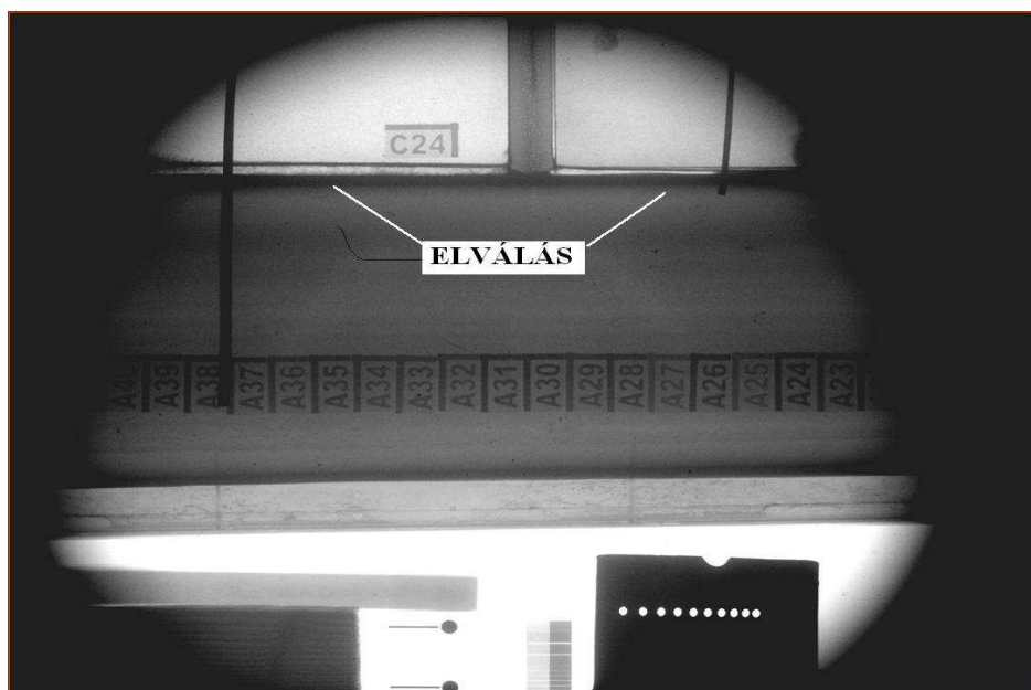
15. ábra. Szektor és főtartó közötti elvállás NR képe egy Ka-26 rotorlapátban
