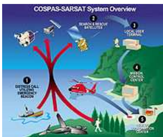
4. ábra – A COSPAS-SARSAT rendszer működési alapja
