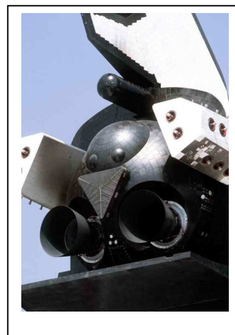
7. és 8. ábra. A Burán fékező ejtőernyőinek hármass fűrtje és a fékejtőernyő gondolája a függőleges vezérsík alatt
