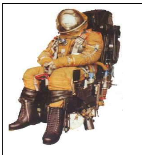
9. és 10. ábra. A K-36 típusú katapultülés és a Buran pilótafülkéjébe beépítésre tervezett módosított változata
