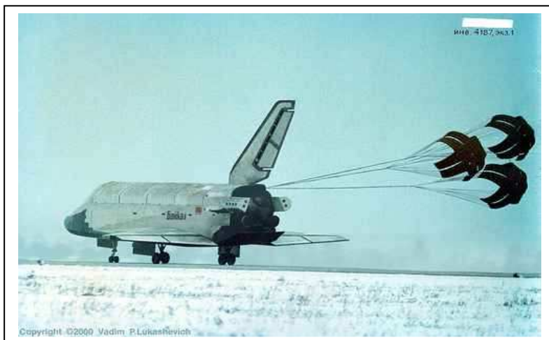
7. és 8. ábra. A Burán fékező ejtőernyőinek hármass fűrtje és a fékejtőernyő gondolája a függőleges vezérsík alatt
