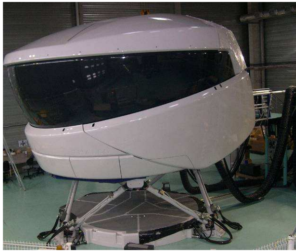
9. ábra A Thales cég SSJ-100 FFS berendezése
