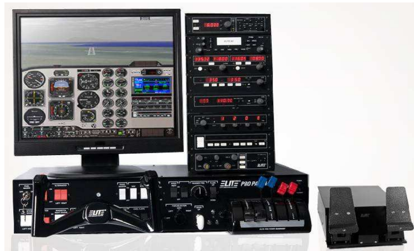
5. ábra Cessna-172 repülőgép kialakítását szimuláló ATD
