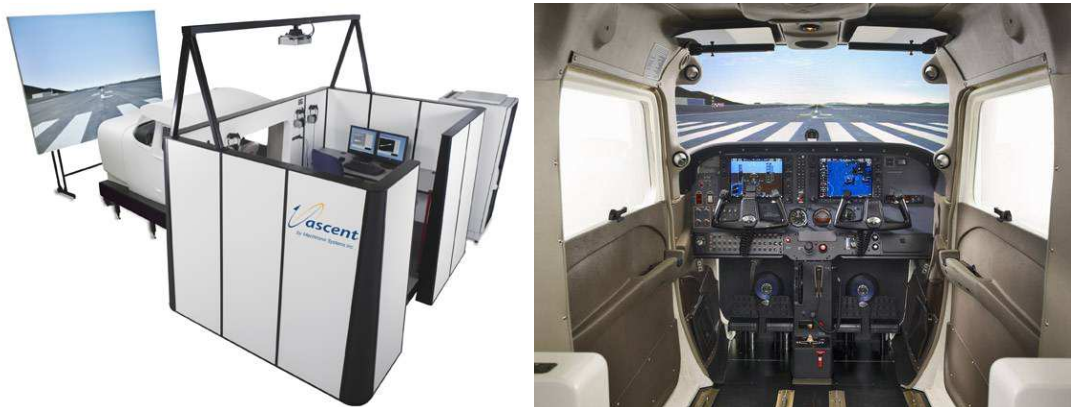
7. ábra: A Cessna repülőgépcsaládra kifejlesztett FNPT berendezés
