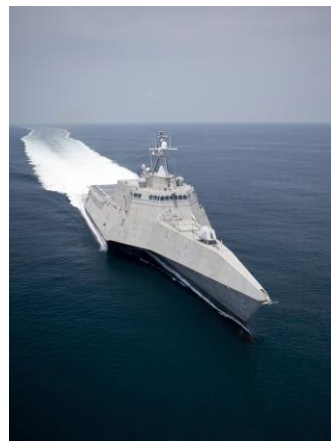
4. ábra Két GE LM 2500-as gázturbina képezi a fenti 127 m hosszú US Partiőrség hajójának erőforrását [4]
