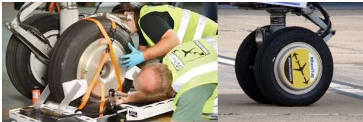
6. ábra A WheelTug® szerelés közben és rögzítve egy Boeing-737 orrfutó kerekén [1][14]
