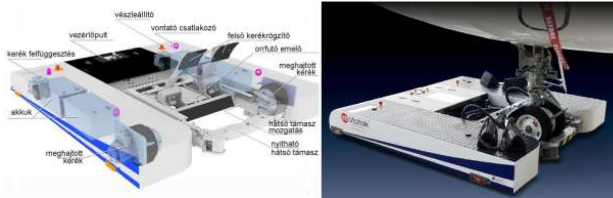
8. ábra Mototok Twin akkumulátoros önjáró toló-vontató jármű [8]
