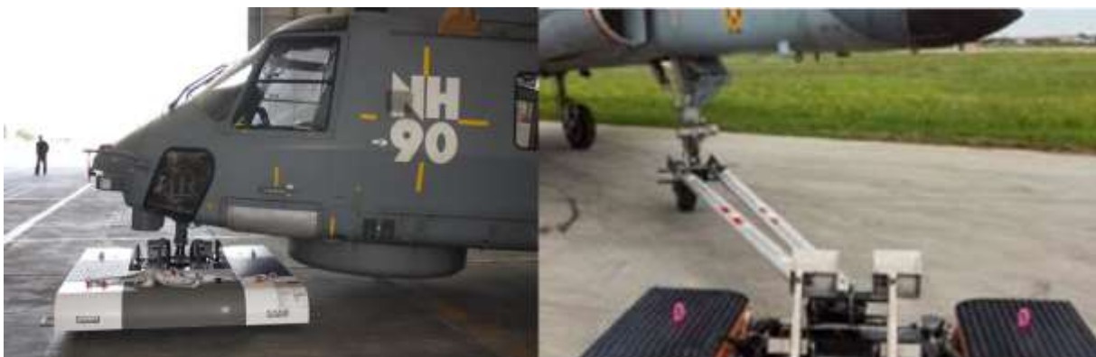
9. ábra Helikopter mozgatása Mototok rendszerrel[7]
