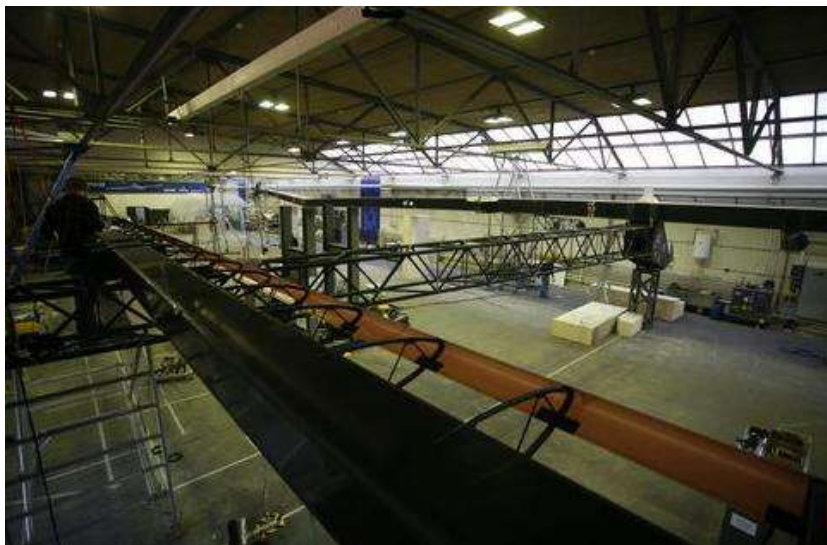
4. ábra Solar Impulse repülőgép sárkányszerkezete 8
