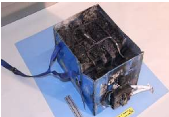
10. ábra B-787 felrobbant Li-Ion akkumulátora 14
