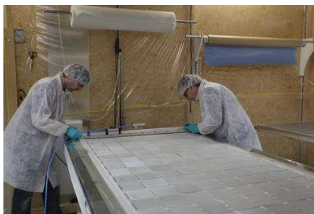
2. ábra Napelem panelek összeállítása 6
