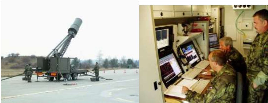
3. ábra A VERA passzív vevőberendezés antenna rendszere és vezetési pontja 5 6
