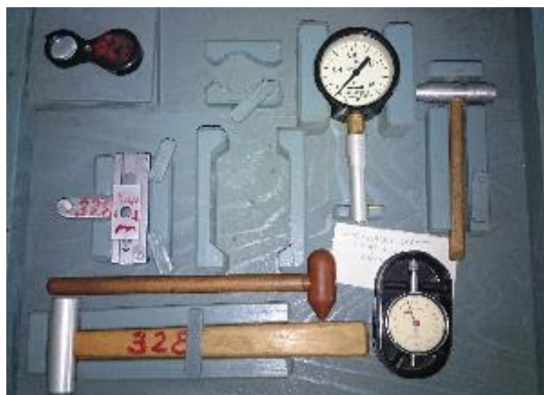
15. ábra A lapátsérülés ellenőrző készlet, benne a kopogtató kalapácsok [saját fotó]
