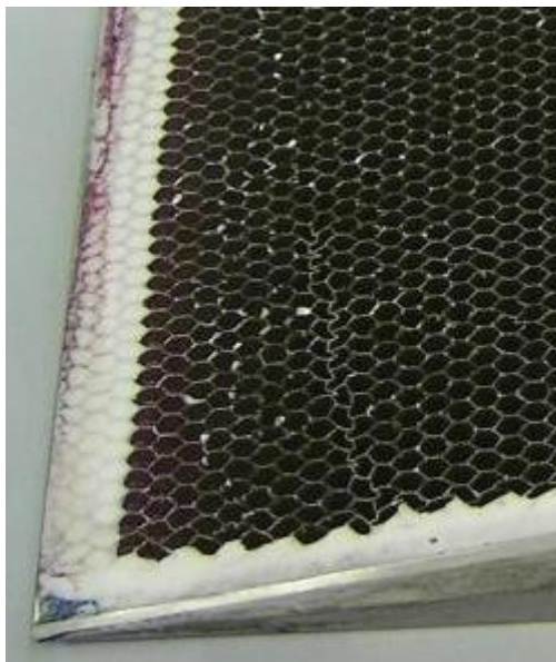
14. ábra Sérült és ép részeket is tartalmazó méhsejt szerkezet [saját fotó]
