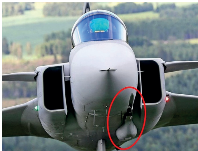
5. ábra Mauser BK-27 gépágyú elhelyezkedése a JAS-39-en [14]
