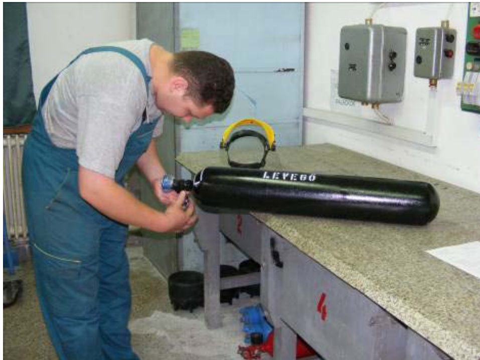
8. ábra. Nyomástartó edények ellenőrzése [Forrás: MH Lé.Jü.]
