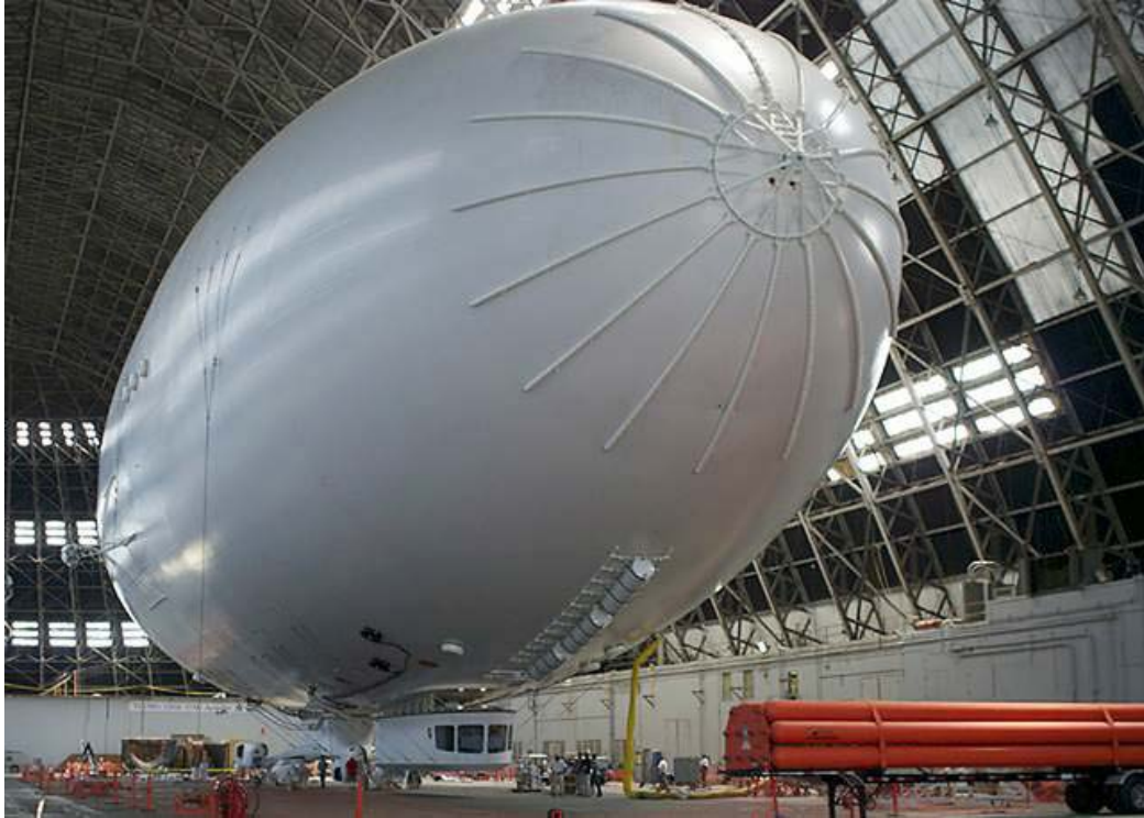
8. ábra. A félmerev szerkezetű amerikai M-1400 típusú léghajó
