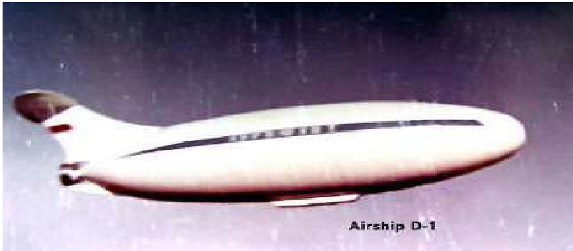
6. ábra. A gázturbinás meghajtású szovjet D-1 léghajó
