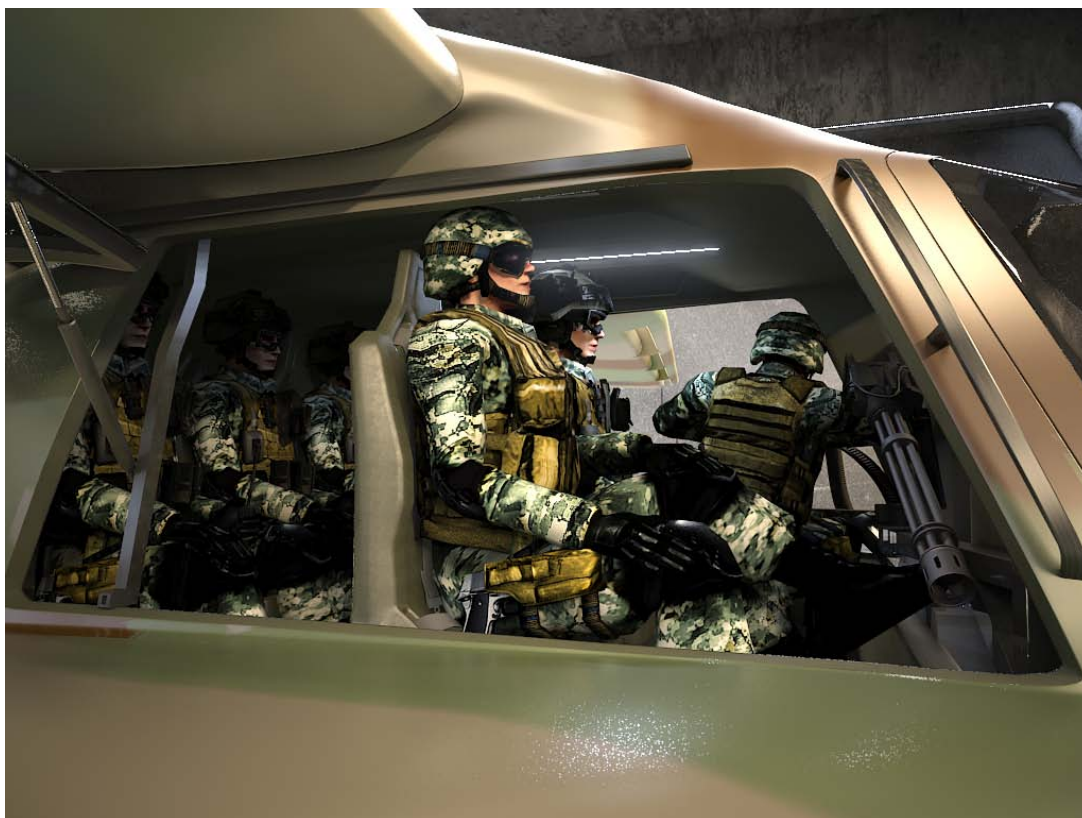
2. ábra. A kétoldali csöves önvédelmi fegyverzet és az utastér
