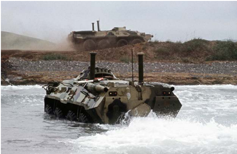
33. ábra. BTR-80 páncélozott jármű vízszugárhajtóműve működés közben. Segítségével a jármű vízben 9 km/h sebességgel mozoghat
