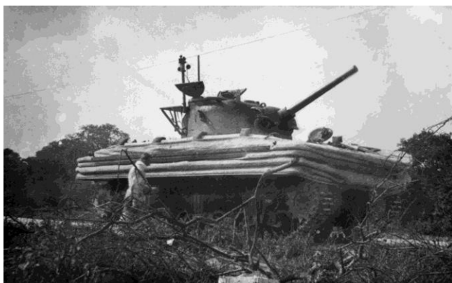
17. ábra. A Sherman „DD” harckocsi összehajtott Straussler-féle úszóköpennyel
