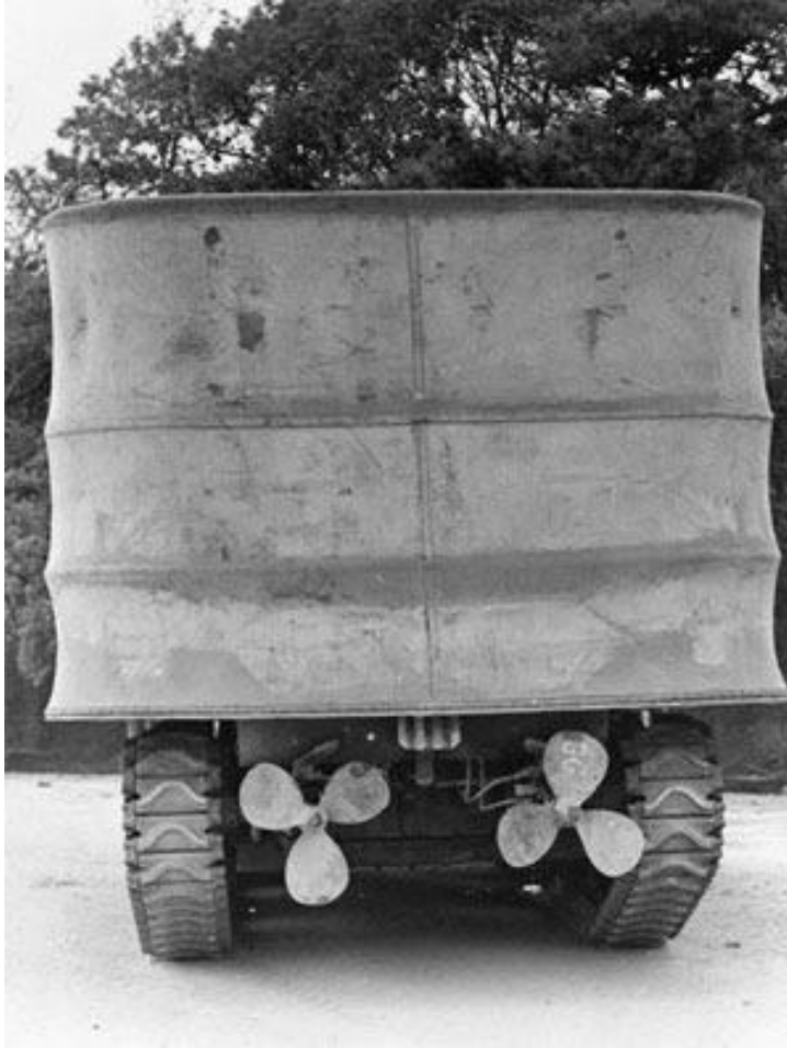
19. ábra. „DD” Sherman harckocsi kettős hajócsavar-hajtással
