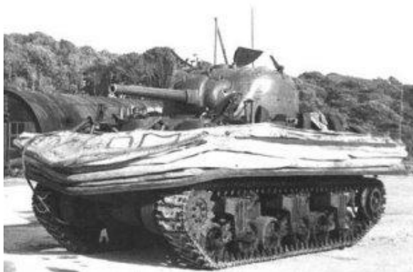
16. ábra. A Sherman „DD” harckocsi összehajtott úszóköpennyel
