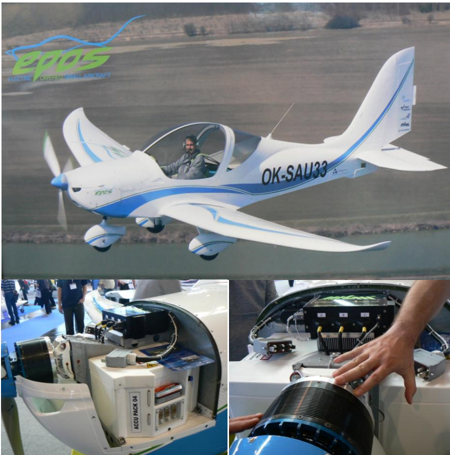
4. ábra. Epos, tisztán elektromos hajtású repülőgép 1 óra repülési idővel
