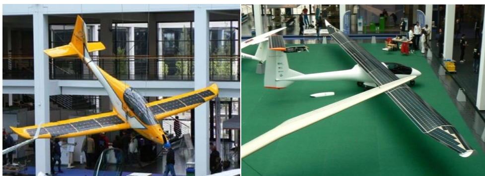
7. ábra. Napelemes, akkumulátoros energiatárolású repülőgépek a Friedrichshafen-i repülőkiállításon 11
