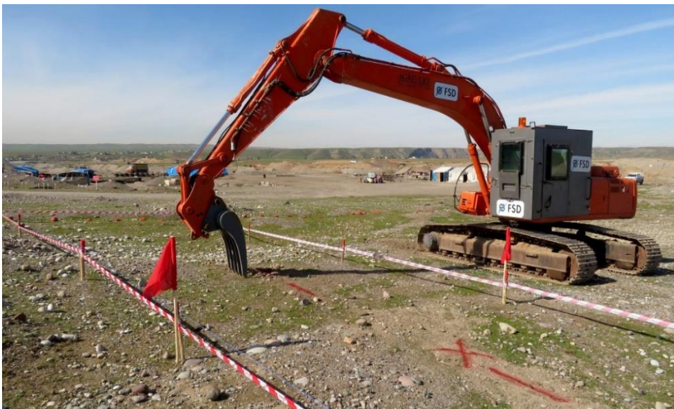
7. számú ábra. Megerősített kezelőfülkével rendelkező kotrógép alkalmazása Irakban 38
