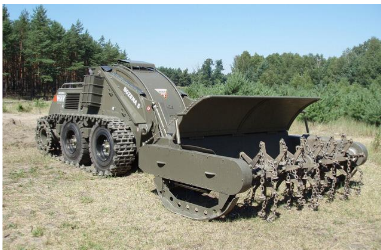
4. számú ábra. A szlovák gyártmányú Bozena-5 ütőhatású aknamentesítő eszköz 31
