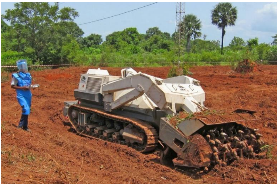
6. számú ábra. Távirányított kultivátor alkalmazása Szenegálban 36
