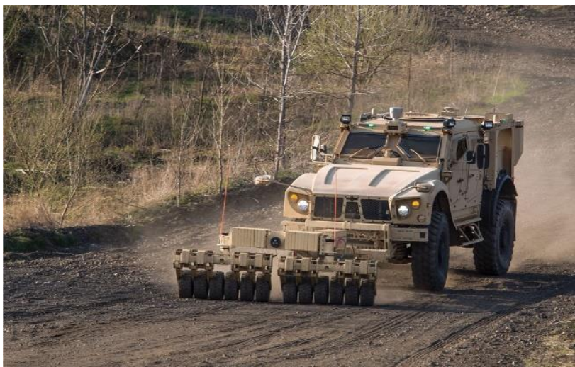
9. számú ábra. M-ATV járműre szerelt aknataposó henger útfelderítés közben 42
