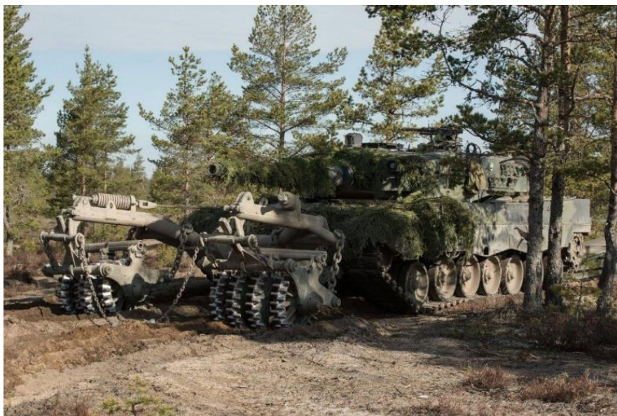
8. számú ábra. Aknataposó hengerrel felszerelt Leopard 2A4 harckocsi finnországi gyakorlaton 39
