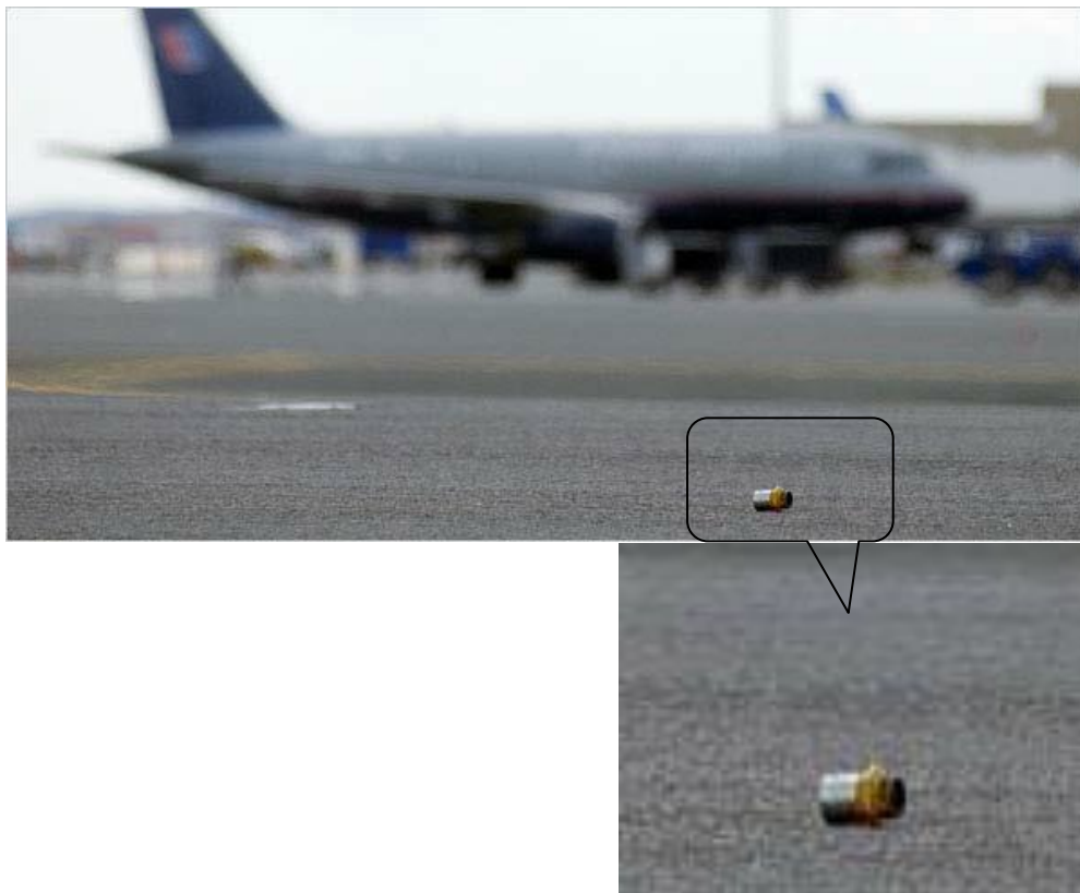
2. számú ábra. FOD egy repülőtér gurulójának felületén 15
