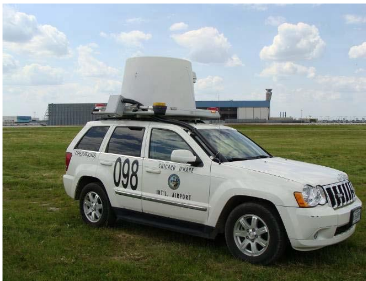
6. számú ábra. Trex Enterprises nevű FOD-keresőradar és infravörös kamera a Chicago O'Hare (ORD) repülőtéren, egy repülőtéri gépjármű tetején elhelyezve. 19
