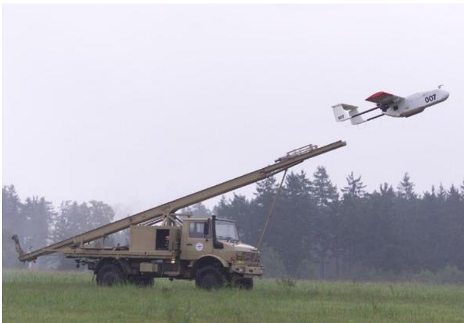
2. számú ábra. Szojka UAV felszállása az indítójárműről. Katapultról indítható és ejtőernyővel vagy csúszótalpra (és egy felfújódó „légsákra”) száll le
