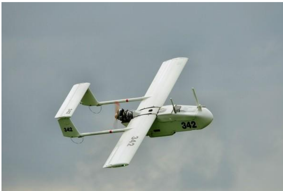
1. számú ábra. A 30 kW-os Wankel-motoros Szojka III a levegőben, melynek sárkányszerkezete magyar gyártmányú, szálerősítésű kompozit műanyag 2
