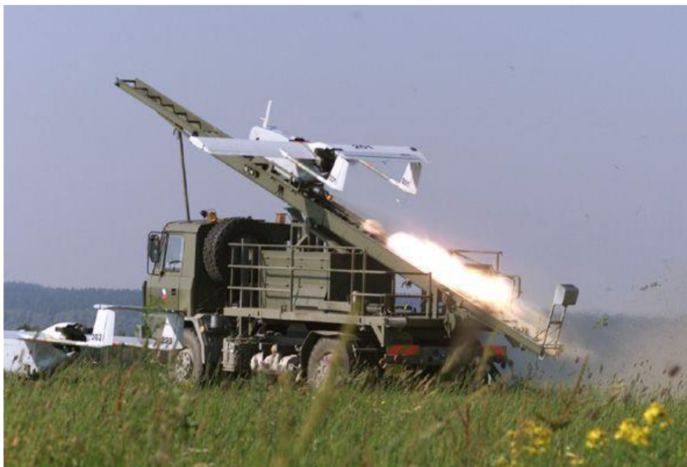
12. számú ábra. Az UAV indítása katapultról 1 tonna tolóerejű startrakétával 21
