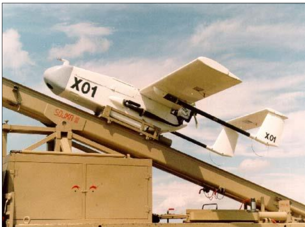
6. számú ábra. A Szojka UAV az indítóállványon. Jól látható a motor halk üzemét lehetővé tevő, feketére festett hangtompító és áramvonalazó burkolata, illetve az indító kocsi 12
