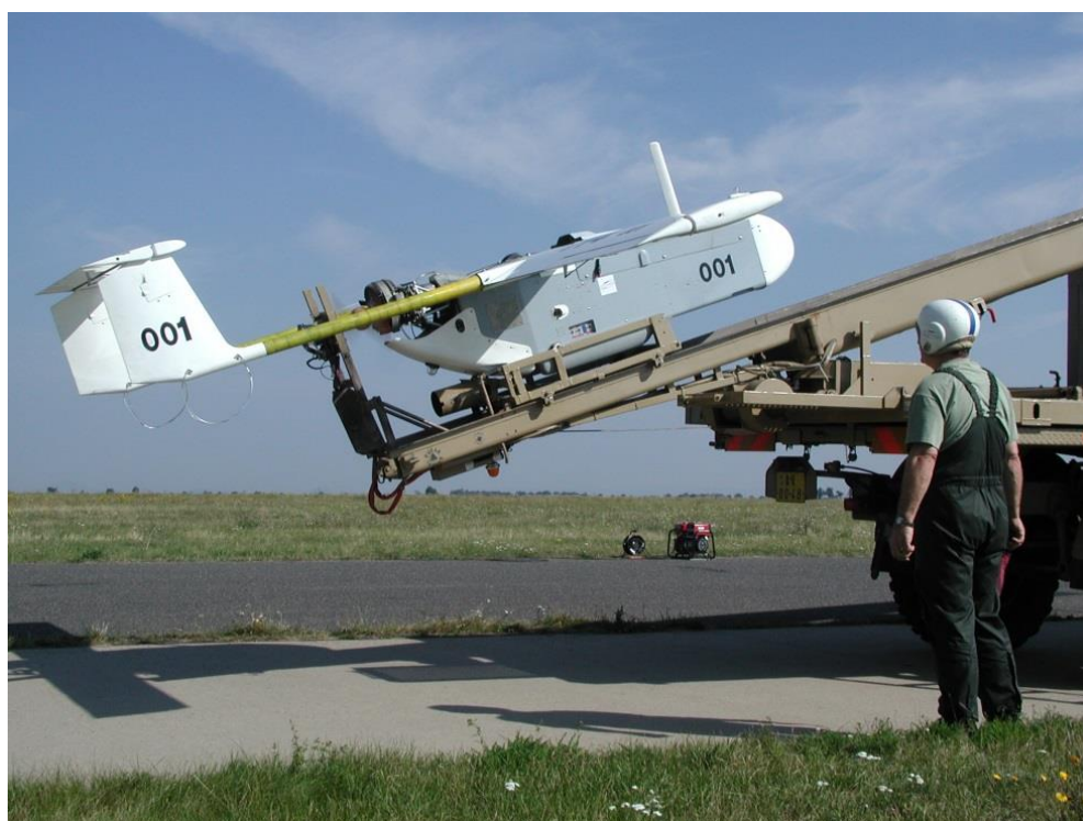
18. számú ábra. Wankel-motoros Szojka-variáns az indítógépkocsi állványán. Jól látható a gyorsítórakéta
