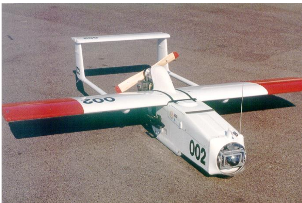
7. számú ábra. Korai Szojka UAV orrkamerás kialakítással és a 4 m fesztávolságú szárnyal 15
