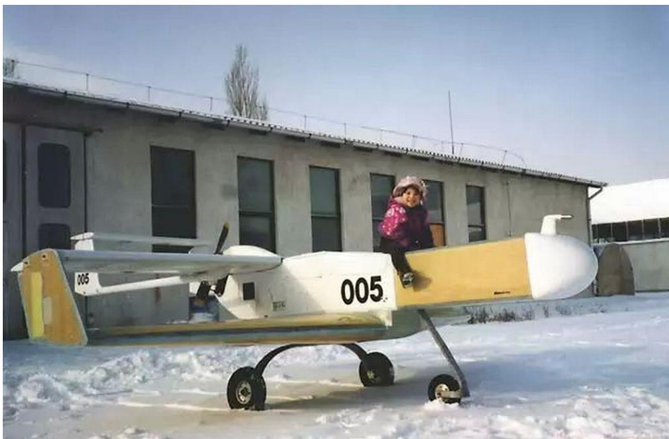
24. számú ábra. Kísérleti Szojka UAV kerekes futóművel és a szárnyfelület növelése érdekében létrehozott csatolt szárnszerkezettel 29
