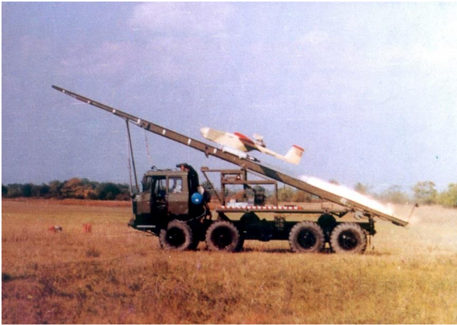
13. számú ábra. A Szojka UAV korai változata a segédtrakétás indítás során 12 méteren éri el a 130 km/h-s startsebességet
