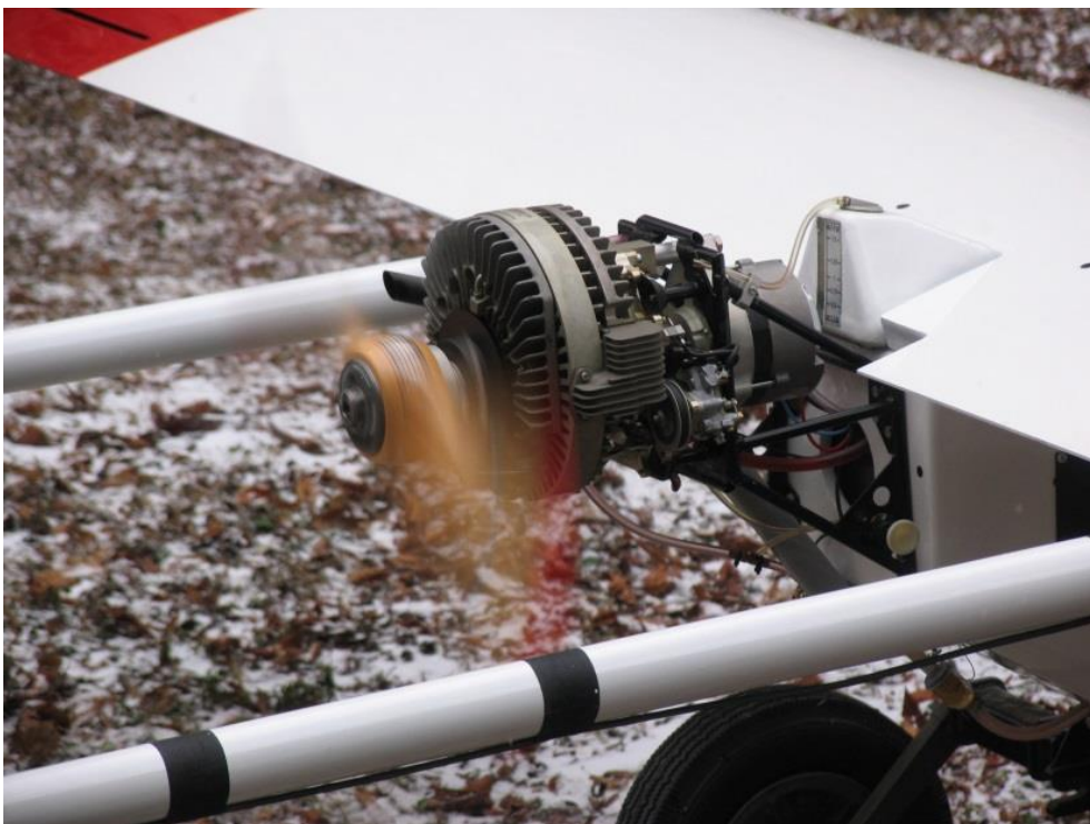
8. számú ábra. A Szojka kis homlokfelületű és légellenállású, könnyű és rezgésmentes Wankel-motorja. A Wankel-erőforrás földi próbái 2006-ban a HM Technológiai Hivatalnál
