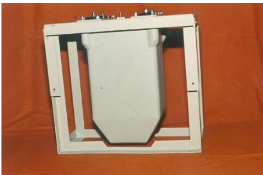
17. számú ábra. A Szojkához fejlesztett gammasugárzás-mérő szonda 26
