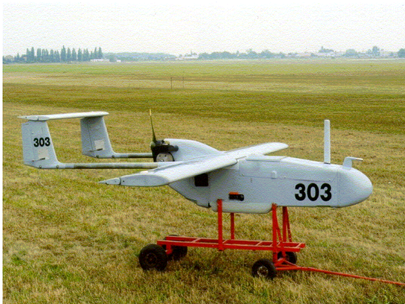
3. számú ábra. Szojka UAV a kéthengeres kétütemű léghűtéses bokszermotor-variánssal 9
