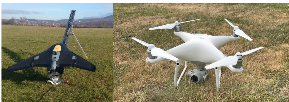
7. számú ábra. A 2017. évi jeges árhullám légi megfigyelésére alkalmazott Trimble UX5 és DJI Phantom drónok (Készítette: ÉMVIZIG, FETIVIZIG)
