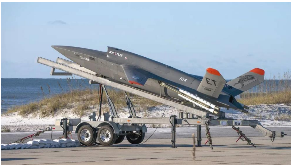
6. számú ábra. Az XQ-58A Valkyrie UAV egyszerű katapultról indítható, rakéta segítségével 31
