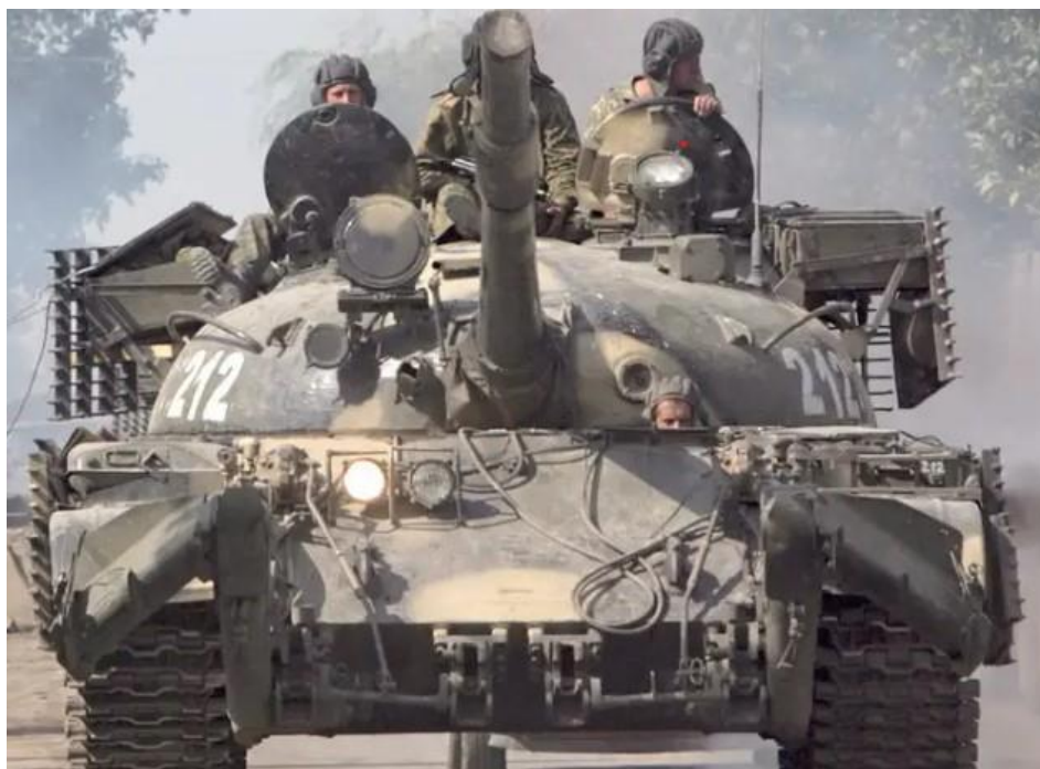
10. számú ábra. Egy rácspáncélzattal felszerelt modernizált T-62M alapharckocsi Georgiában [51]
