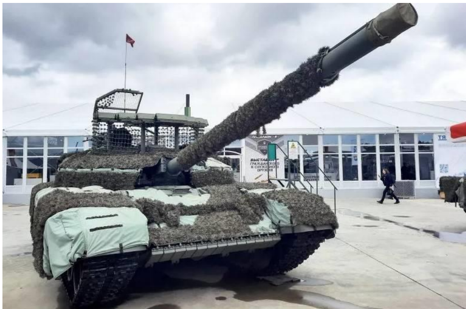
14. számú ábra. Orosz T-72B3 típusú alapharckocsi drónvédelmi ráccsal, elektronikus zavaróeszközökkel és hőkibocsátás-csökkentő leppellel „felvértezve” [70]
