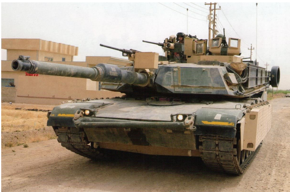
8. számú ábra. Egy M1A1 Abrams harckocsi TUSK, városi harcra kialakított védelmi csomaggal felszerelve [40]
