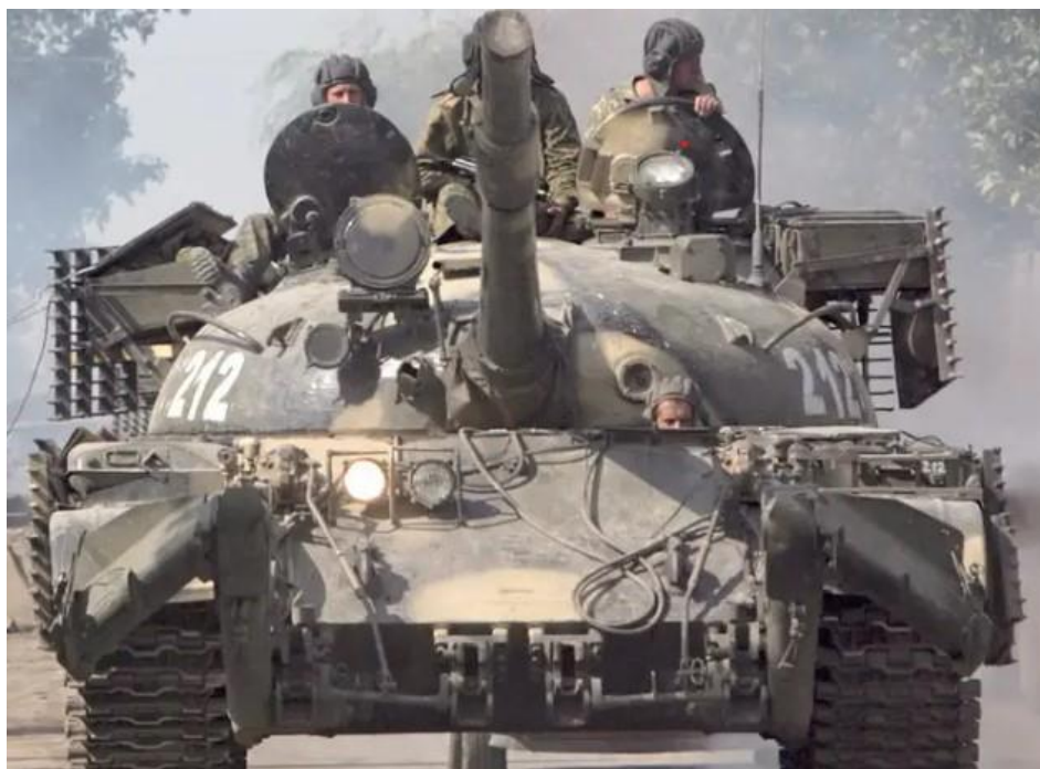
10. számú ábra. Egy rácspáncéllal felszerelt modernizált T-62M alapharckocsi Georgiában [51]
