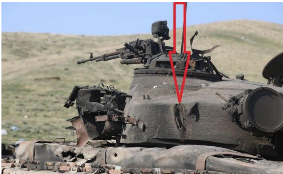
13. számú ábra. Egy örmény T-72B alapharc kocsiért öngyilkos dróntalálat kumulatív sugarának bemeneti nyílása [65]
