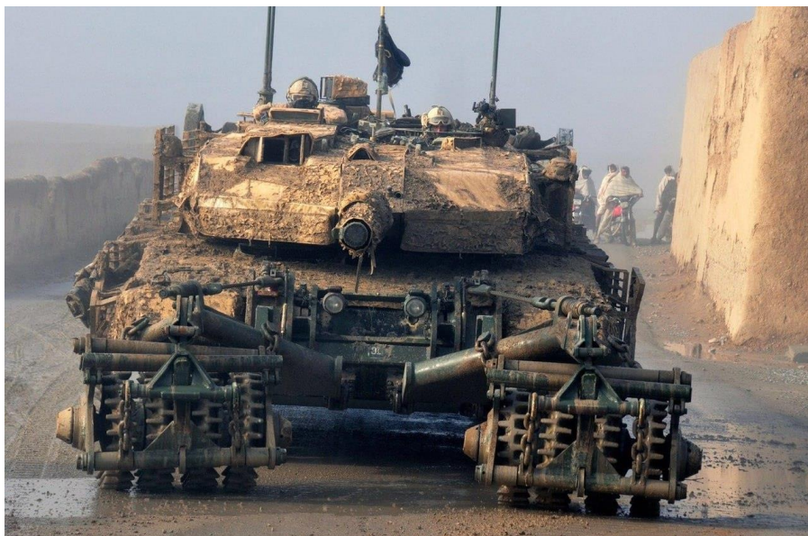
9. számú ábra. Kanadai Leopard 2A4M CAN harckocsi szovjet KTM-5 aknataposó rendszerrel egy afgán faluban [46]
