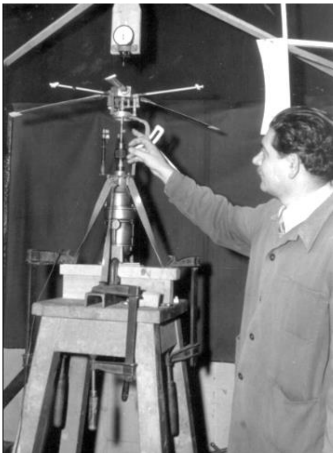
23. számú ábra. Hatházi Dániel a BME Tudományos Diákkörének foglalkozásán a modell rotorfejjel végzett mérések közben (Forrás: BME Topoteka engedélyével, képszám: 0381961)
