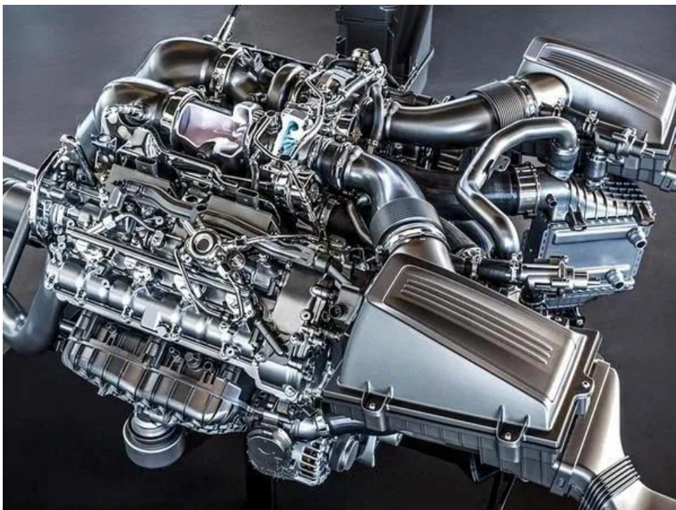
2. számú ábra. A Mercedes–AMG GT V-8 biturbó HSI motorja a hengerek közti turbófeltöltővel 15
