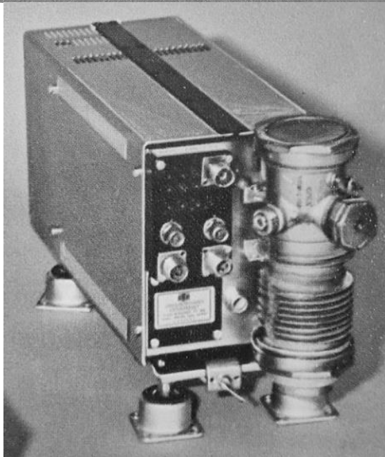
4. számú ábra. A FAK-FAV rendszer SzOD-57MA kísérleti változata (FAK-ot, magasságkódolót is tartalmazó fedélzeti aktív válaszdó, cserével „beépítve”)
