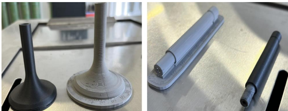
6. számú ábra. Markforged MetalX nyomtatóval nyomtatott D2 acél szelep, illetve Onyx One nyomtatóval nyomtatott, a szén-szál-tartalomtól fekete Onyx kompozit szelep (Fotó: Hegedűs Ernő)
