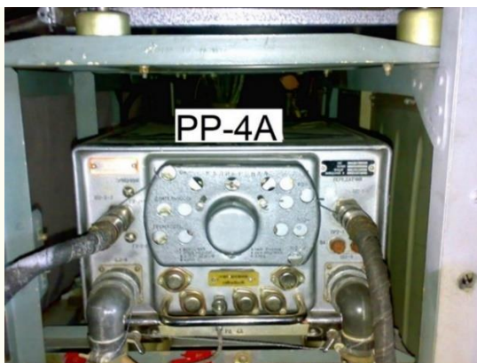
115. számú ábra. Az RV-4 rádió-magasságmérő PP-4A adó-vevője - forrás 54
