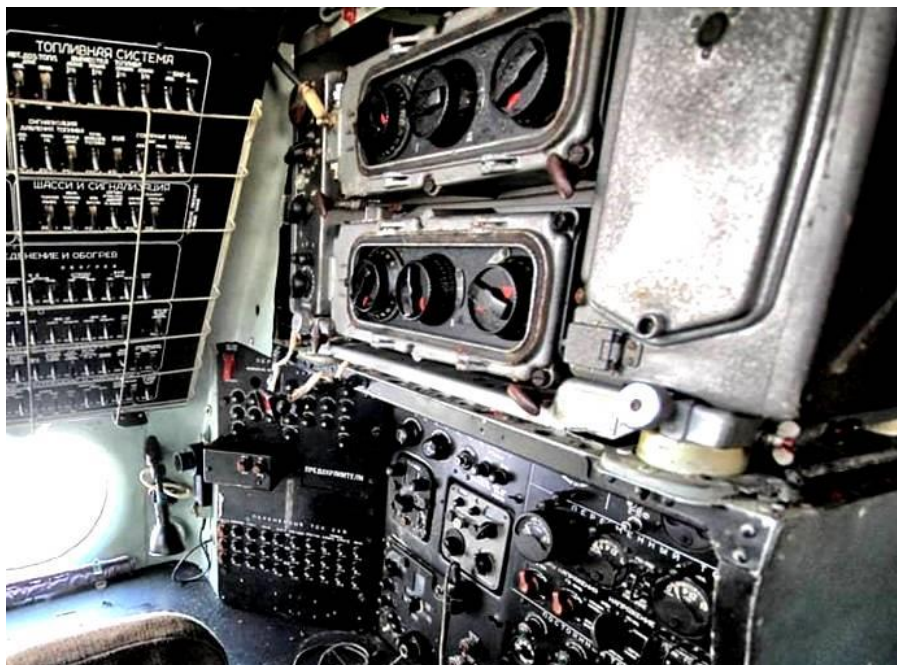
40. számú ábra. Az R-836 adó a fedélzeti rádiós műszerfalának felső részén (igaz, a képen An-24V-re volt beépítve, de az An-26-on is ugyanezt a helyet használták – erről sajnos nem találtam fényképet) – forrás: a volt Szolnoki Repülőkúzeum archívuma
