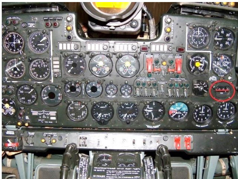
34. számú ábra. Az SzD-67 IDR-1M (vagy IDR-1B) jelzőműszere a II. repülőgépvezető műszerfalán (piros körrel jelölve) – az MH Lé. Jü. felvétele
