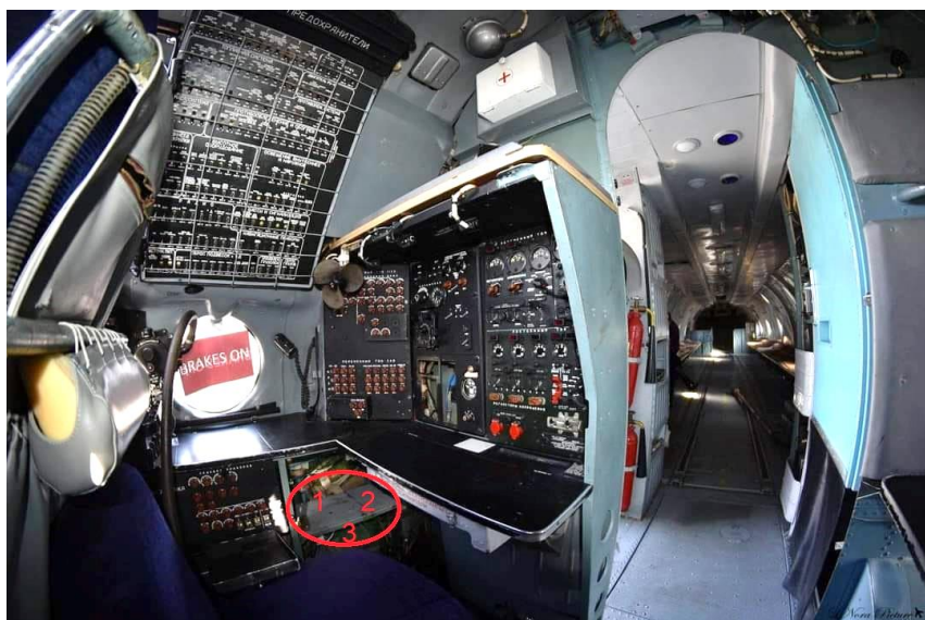
99. számú ábra. Az MT-3811 rezgéscsillapító kereten elhelyezett RT-1157V adó-vevő (1. pozíció), az SSD-120-62E magasságkódoló (2. pozíció) és a KIT-1C titkosító (3. pozíció) beépítési helye (piros körrel jelölve) – Letanóczki Nóra felvétele
