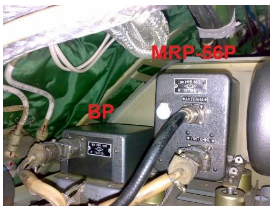
46. számú ábra. Az MRP-56P markervevő és a BP tápblokk a tehertér elején, bal oldalon, a 9-10. törzskeretnél lévő rádióberendezés-polcon - forrás 32
