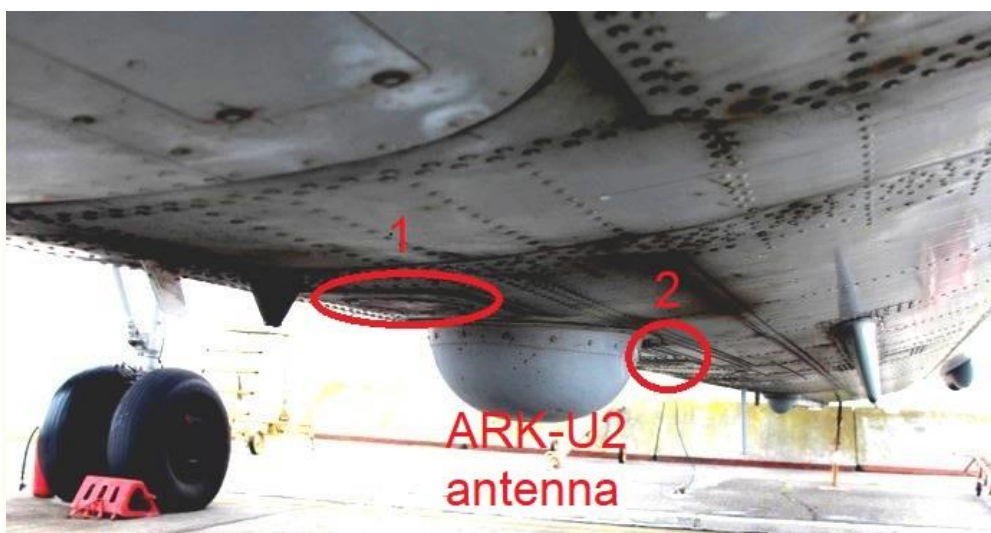
124. számú ábra. Az RV5-1-2 tölcsérantennák borítása az An-26 törzse alatt; az ARK-U2 rádióiránytű keretantenna-borítása előtt a vevő-antenna (1. pozíció), míg mögötte az adóantenna (2. pozíció) lett beépítve (a szerző felvétele, Kecskemét, 2024.05.03.)
