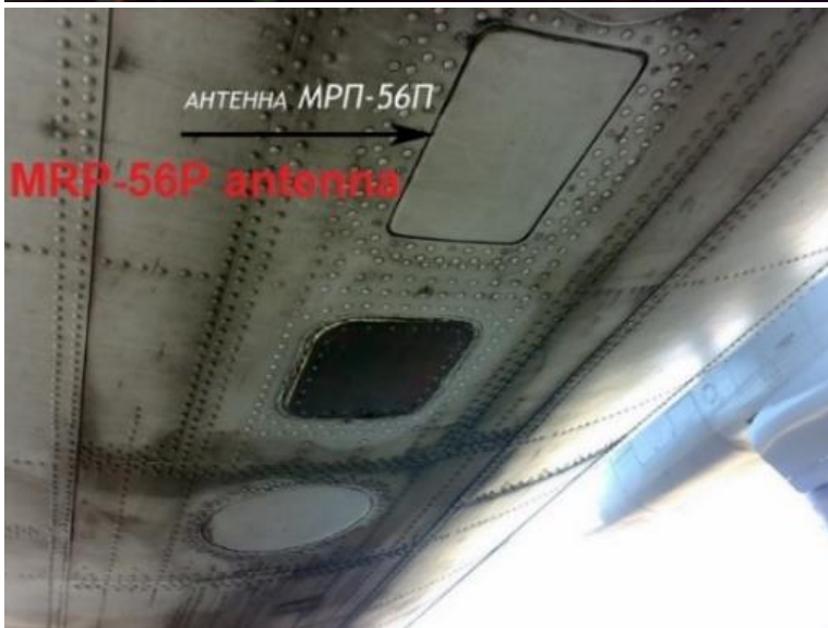
53. számú ábra. Az MRP-56P markervevő antennája a tehertér padlózata alatt (a.) és fedőlemeze az An-26 törzsének alján, a 13-14. törzs-kereteknél (b.) - forrás 32
