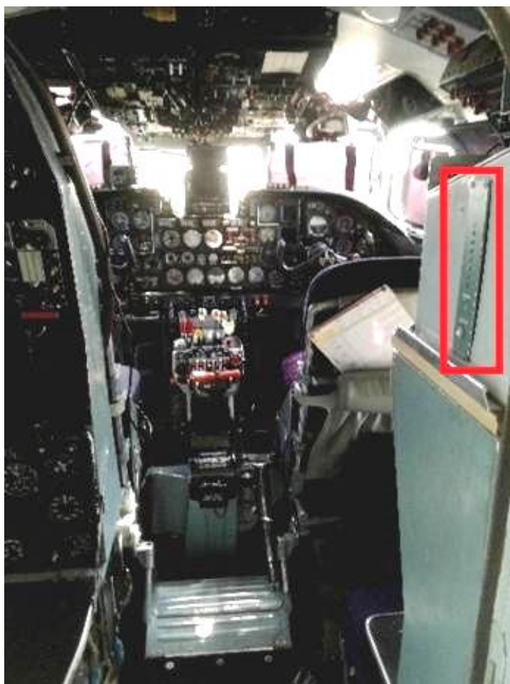
170. számú ábra. Az SzPSz-BGO tűzjelző rendszer jelzőblokkja az An-26 típusú gépen (piros színnel kijelölve) – a szerző felvétele, Szolnok, 2019.08.24.
