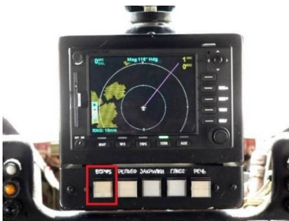
167. számú ábra. A KMD-540 TFI a repülőgépvezetők előtti műszerfalán, alatta az EGPWS kezelőgombja (piros színnel jelölve) – az MH Lé. Jü. felvétele
