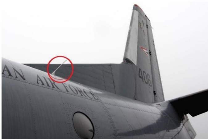
173. számú ábra. A 406-os An-26 repülőgépen a C406-1 vészhelyzetadó 110-338 számú antennája (a szerző felvétele, Kecskemét, 2024.05.03.)
