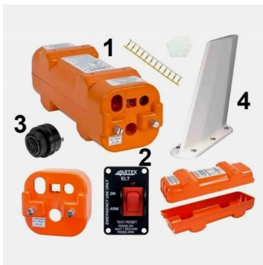
171. számú ábra. A C406-1 vészhelyzetadó készlete – forrás 73
