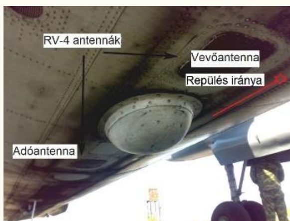
118. számú ábra. 2 db AR11-4A típusú, adó-, illetve vevőantenna - forrás 54
