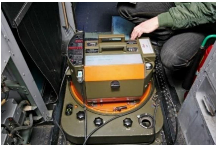
18. számú ábra. RC-30 típusú légifényképezőgép a magyar An-26 típusú repülőgép törzsének elején található, alsó vészkijárat nyílásában (az MH Lé. Jü. felvétele)
