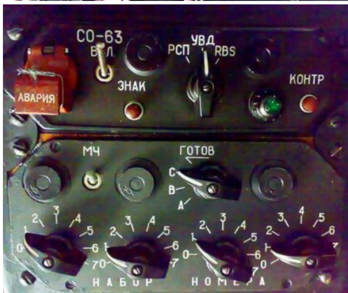
27. számú ábra. A SzOM-64 válaszadó vezérlőpultja a repülőgép-vezetők felső műszerfalának kiegészítő paneljén (piros négyszöggel kijelölve) – forrás: Letanóczki Nóra felvétele (a.); a kijelölt vezérlőpult kinagyított képe (b.) - forrás 27
