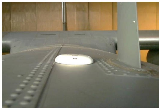
85. számú ábra. A CCNS-4 rendszer GPS-antennája a Baklán-20 VHF rádió antennája mellett, a törzs felső részén (a repülőgép orr-része felől nézve) + lásd a 89. számú ábra 3. pozícióját (az MH Lé. Jü. felvétele)
