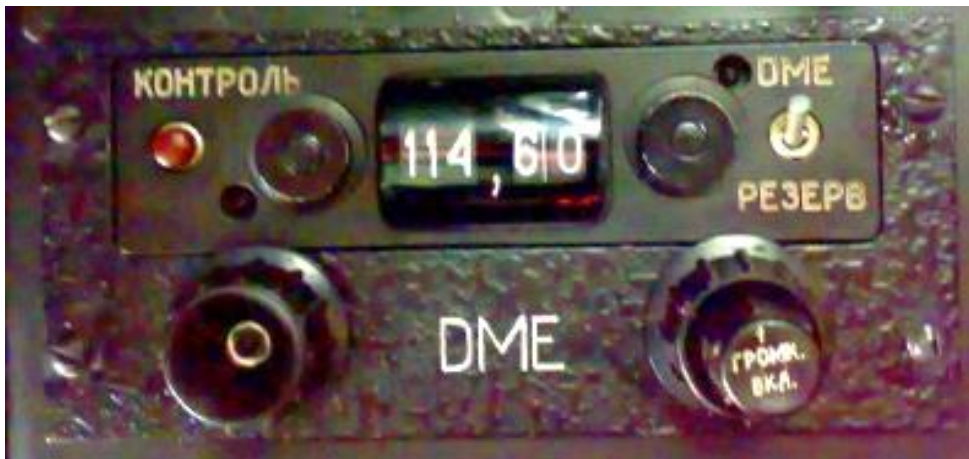
32. számú ábra. SzD-67 távirányító pult - forrás 29
