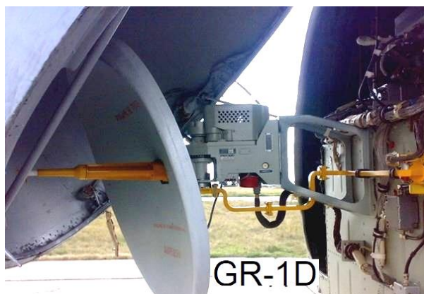
132. számú ábra. A Groza-26 MRLÁ GR-1D antennablokkja a 110-es An-26 repülőgép. orrkúpja alatt (a 2008-ban végrehajtott modernizálásig) – forrás 59
