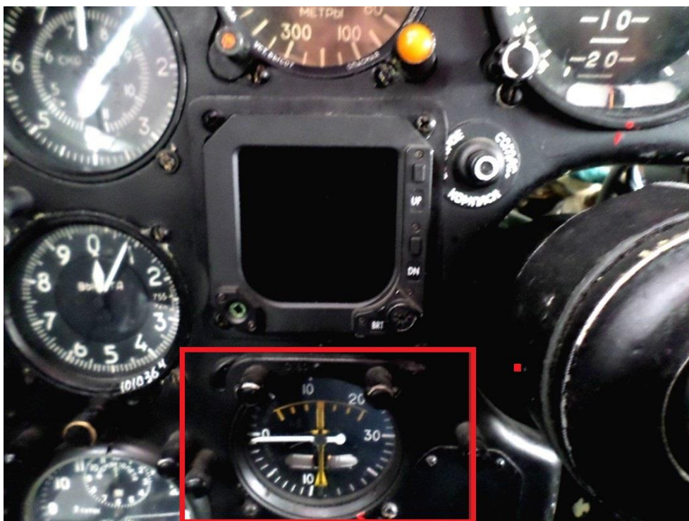
176. számú ábra. A DA-30P egyesített műszer az I. repülőgépvezető műszerfalán, az IVA-81D jelzőműszer alatt (piros színnel kijelölve) – a szerző felvétele, Kecskemét, 2024.05.03.
