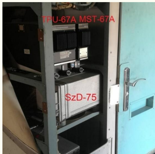
145. számú ábra. Az SzD-75 távolságmérő blokk, beépítve az An-26 repülőgép teherterének elején, bal oldalon, a 9-10. sz. törzskereteknél lévő rádióberendezés-polcon (a szerző felvétele: Szolnok, 2019.08.24.)
