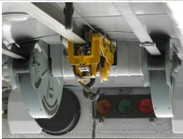
9. számú ábra. a. An-26 tehertér a személyzeti fülke felé nézve (a szerző felvétele, Szolnok, 2019.08.24.); b. BL-56 fedélzeti daru az An-26 repülőgép teherterének végében (Szuromi Albin felvétele)
