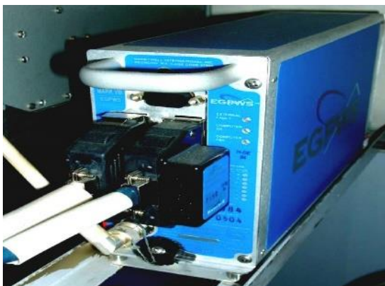
165. számú ábra. Az EGPWS számítóblokkja és az elosztódoboz az An-26 típusú repülőgépen (az MH Lé. Jü. felvétele)
