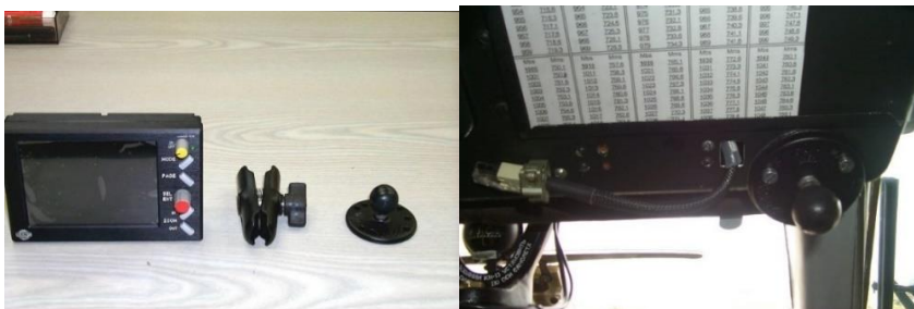
82. számú ábra. A repülőgépvezetők TFT-kijelzője (a.) és a rögzítésére szolgáló gömbcsuklós szerkezet felszerelve (b.) - a TFT-kijelző természetesen nincs rajta, azt mindig az adott NyÉ feladat előtt helyezték fel a légifényképezést végző szakemberek (az MH Lé. Jü. felvételei)
