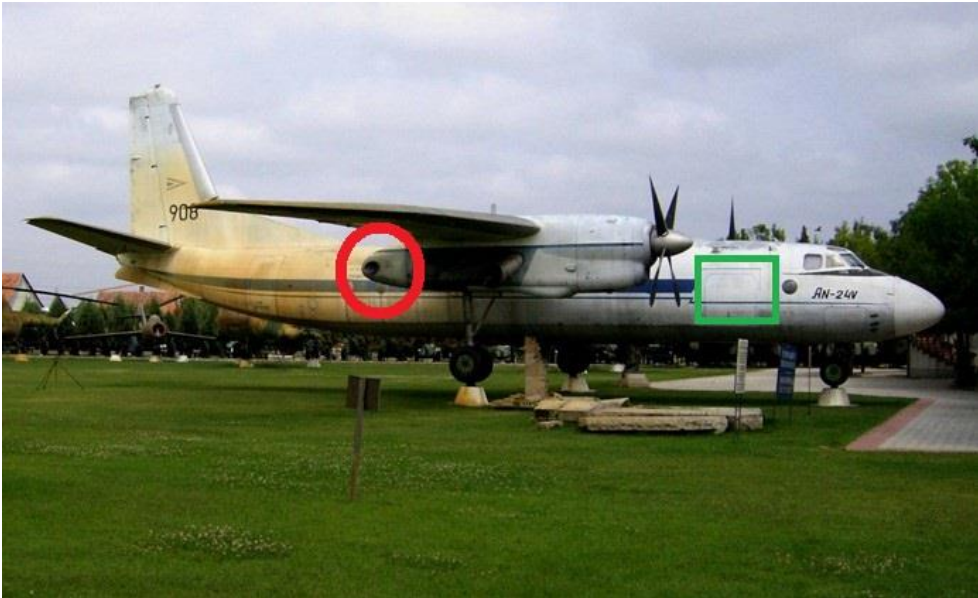
5. számú ábra. A 908 oldalszámú An-24V típusú repülőgép a Keceli Hadtörténeti Múzeumban. Piros körrel jelölve a TG-16 segédhajtómű gázkiáramló csöve a jobb oldali AI-24 főhajtómű gondolája végén, zöld négyszöggel a csomagok be- és kirakodására szolgáló ajtó (a szerző felvétele, Kecel, 2009.06.26.)
