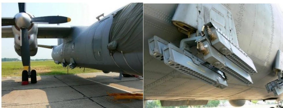
107. számú ábra. Az ASzO-2V-8700-0 tartó (kivehető kazettával) elhelyezése a repülőgép bombatartóin, mindkét oldalon (a.); 1 db bombatartón 1 db 4-es fűrt a patronokat tartalmazó kazettákkal (b.) – az MH Lé. Jü. felvételei
