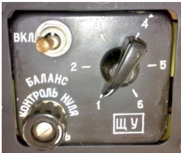
49. számú ábra. ScsU (ЩУ) blokk – SzP-50M távvezérlőpult (a repülőgépvezetők előtti felső műszerfalon) - forrás 32
