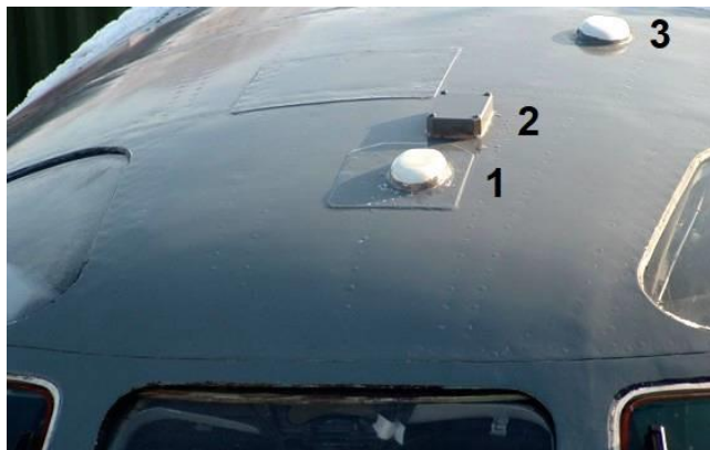
89. számú ábra. GPS-antennák az An-26 repülőgépek törzsének felső részén (a repülőgép orr-része felől nézve) – az MH Lé. Jü. felvétele
