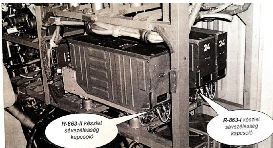
74. számú ábra. Az 1. és 2. sz. R-863M(1) VHF-UHF rádióállomás adó-vevő blokkja a tehertér elején bal oldalon, a rádióberendezések polcán (csak a 110-es An-26 repülőgépen) – az MH Lé. Jü. felvétele
