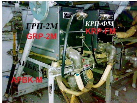
44. számú ábra. A KRP-FM irányászvevő, a GRP-2M sikló pályavevő és az APBK-M blokk elhelyezése a II. repülőgépvezető ülése alatt - forrás 32
