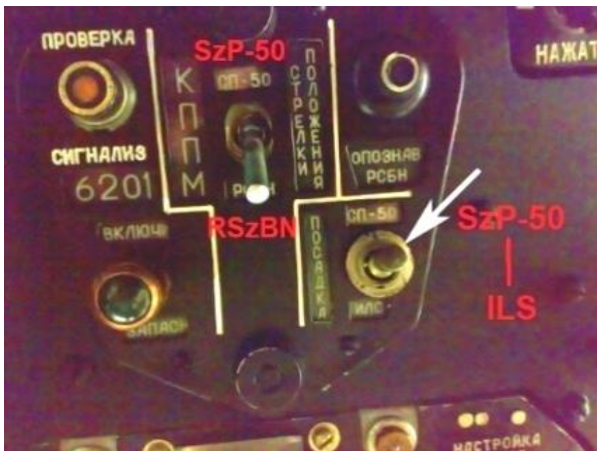
50. számú ábra. Az illesztőblokk az „SzP-50 – RSzBN” („СП-50 – РСБН”) kapcsolóval a közepén, valamint az „SzP-50 – ILS” (СП-50 – ИЛС) kapcsolóval jobb oldalon alul (a repülőgépvezetők előtti felső műszerfalon) - forrás 32
