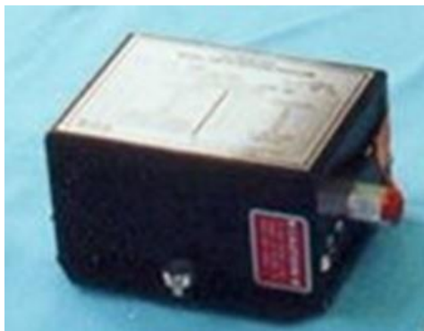
104. számú ábra. Az SSD-120-62E magasságkódoló (az MH Lé. Jü. felvétele)
