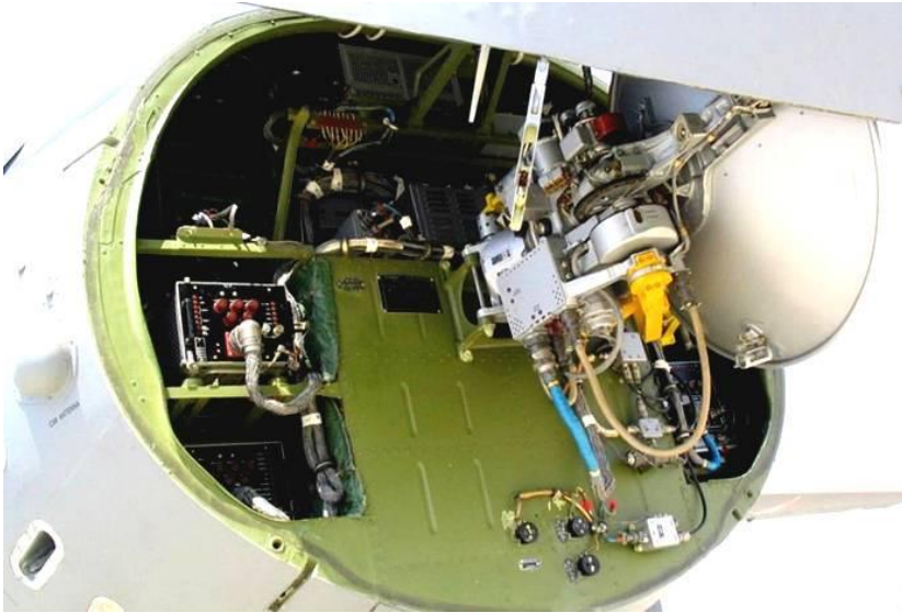
127. számú ábra. Az RPSzN-3N speciális MRLÁ antennája az An-26 repülőgép. üvegtextolit-orrkúpja alatt (a 2008-ban végrehajtott modernizálásig), kivéve a 110 oldalszámú gépet (az MH Lé. Jü. felvétele)
