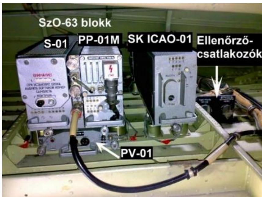
26. számú ábra. A SzOM-64 főbb blokkjai (SzO-63 blokk: S-01 kódoló, PP-01M adó-vevő, PV-01 magasságátalakító, szűrőblokk; SK ICAO-01 kódoló); ellenőrző csatlakozók) - forrás 27
