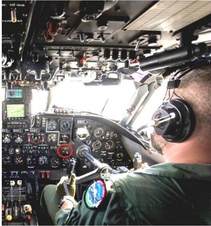
149. számú ábra. Az SzD-75 ferdetávolságmérő ISzD-1 jelzőműszere (piros színnel bekeretezve), a kicserélt SzD-67 távolságmérő IDR-1B műszerének helyén, a II. repülőgépvezető műszerfalán (a felvétel repülési feladat közben készült, forrása nem ismert)
