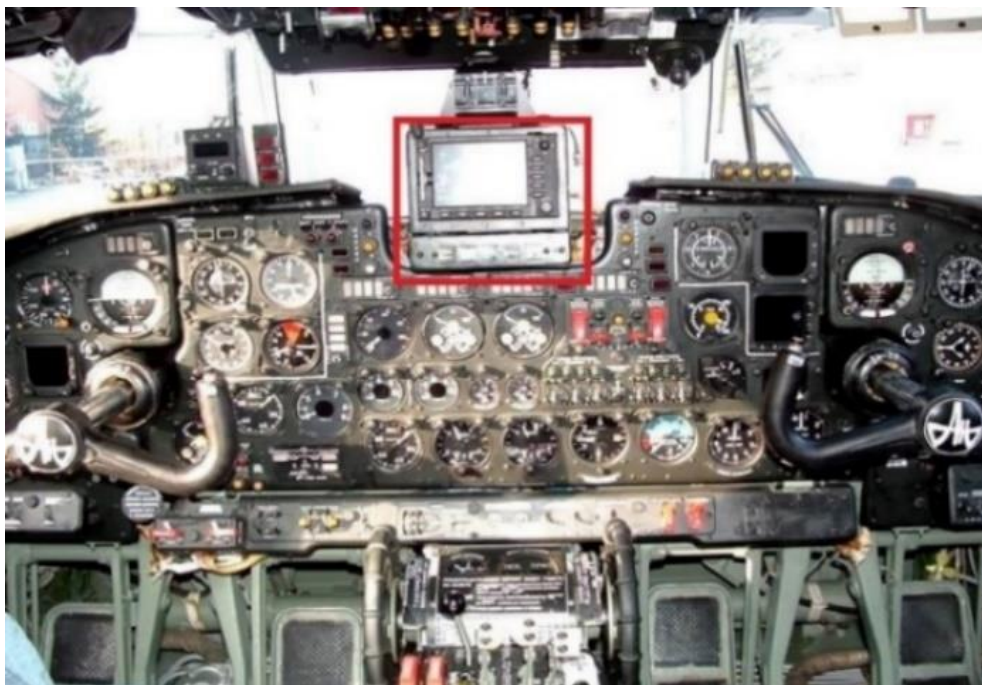
139. számú ábra. A KMD-540 TFI a repülőgépvezetők előtt (piros négyzetben) - az MH Lé. Jű. felvétele
