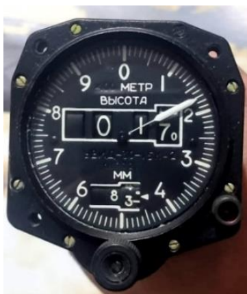
30. számú ábra. UVID-30-15K-2 barométeres magasságjelző (a.) - forrás 29 és a beépítési helye az An-26 személyzeti fülkében, a II. repülőgépvezető előtti műszerfalon (b., piros körívvel jelölve) – az MH Lé. Jü. felvétele
