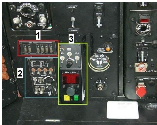
103. számú ábra. Az átalakított vezérlőpult és a különálló kódkapcsoló beépítési helye a fedélzeti rádiós előtti műszerfalon (a szerző felvétele, Kecskemét, 2024.05.03.)
