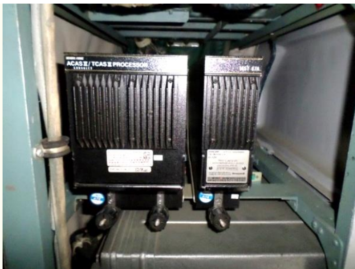
155. számú ábra. A TPU-67A processzor (balra) és az MST-67A „S” módú válaszadó (jobbra) az An-26 típusú repülőgépen (a szerző felvétele: Szolnok, 2019.08.24.)
