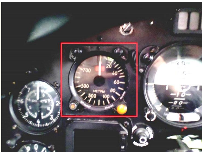
122. számú ábra. Az UV-5M jelzőműszer (piros színnel jelölve) az I. repülőgépvezető előtti műszerfalon (a szerző felvétele, Kecskemét, 2024.05.03.)
