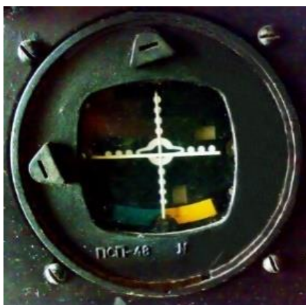
48. számú ábra. PSzP-48 műszer (a fedélzeti megfigyelő műszerfalán) – alkalmazása a II. repülőgépvezető előtt lévő kapcsoló „Megfigyelő” („ШТУРМАН”) állásában lehetséges (lásd az 51. ábrát) - forrás 32
