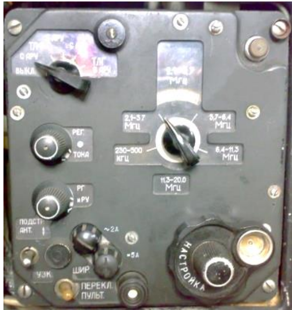
42. számú ábra. Az USz-8K vevő kezelőpultja (1 db a fedélzeti rádiósnál, 1 db a II. repülőgépvezető műszerfalának függőleges paneljén) – forrás 31
