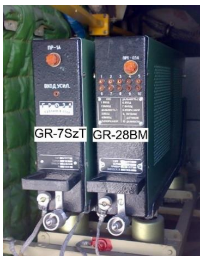
133. számú ábra. A GR-7SzT stabilizáló- és vezérlőblokk és a GR-28BM helyesbítőblokk – forrás 59
