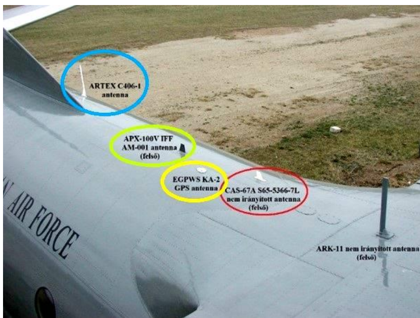
159. számú ábra. Az MST-67A válaszadó ANT L-BAND típusú felső nem irányított antennája a repülőgéptörzsön, a 25-26. törzskeretek között (piros színnel jelölve) – az MH Lé. Jü. felvétele
