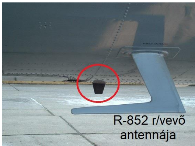
106. számú ábra. Az APX-100V alsó AM-001 (vagy AT-741) antenna beépítési helye (piros színnel jelölve) – az MH Lé. Jü. felvétele
