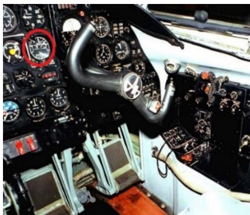
30. számú ábra. UVID-30-15K-2 barométeres magasságjelző (a.) - forrás 29 és a beépítési helye az An-26 személyzeti fülkében, a II. repülőgépvezető előtti műszerfalon (b., piros körívvel jelölve) – az MH Lé. Jü. felvétele
