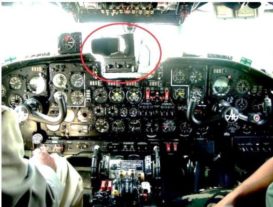
135. számú ábra. A repülőgépvezetők GR-4DV kijelzője (fényvédő tubussal felszerelve) a 110-es An-26 repülőgépen (a kép forrása nem ismert)
