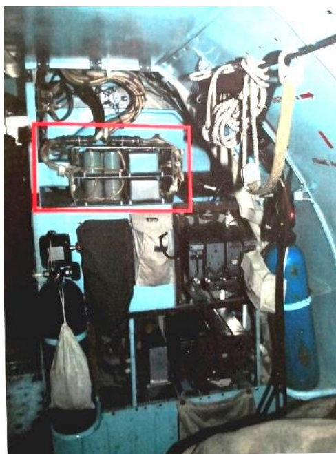
109. számú ábra. Az ASzO-2V 8 db KU-E7R vezérlődoboz és 8 db RV-E7R időreléje (az MH Lé. Jü. felvétele)
