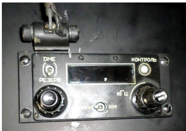
147. számú ábra. Az SzD-75 ferdetávolságmérő PUA vezérlőpultja (a szerző felvétele: Kecskemét, 2024.05.03.)
