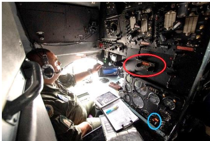
150. számú ábra. Az SzD-75 ferdetávolságmérő PUA vezérlőpultja (piros színnel jelölve) és az ISzD-1 jelzőműszere (kék színnel bekeretezve) a megfigyelő műszerfalán (a felvétel repülési feladat közben készült, forrása nem ismert)
