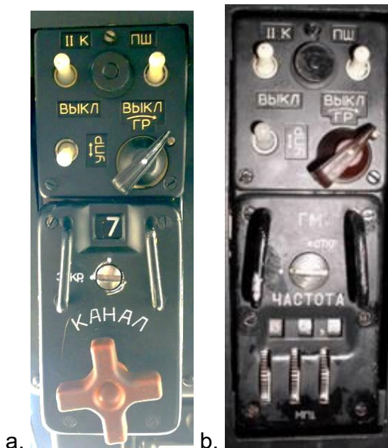
61. számú ábra. Az R-802GM rádióállomás P-2K vezérlőpultja az előre lehangolt 20 csatorna kiválasztójával (a.) és a frekvenciahangolójával (b.) - forrás 34
