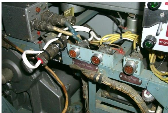
86. számú ábra. A CCNS-4 rendszer csatolóblokkjának csatlakoztatását biztosító tartóegység (a kép közepén) - az MH Lé. Jü. felvétele
