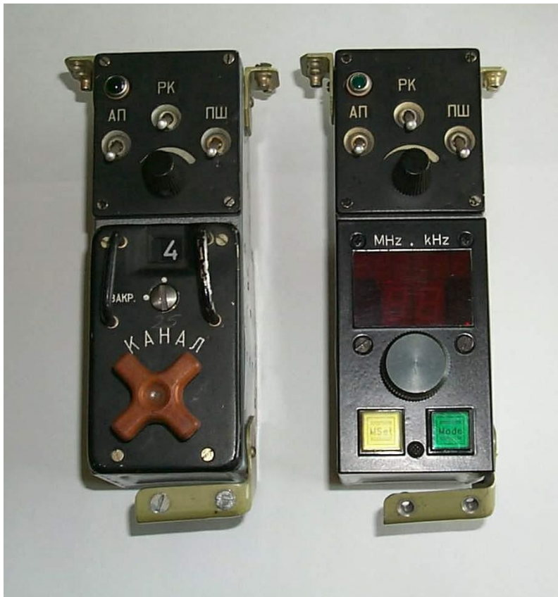
70. számú ábra. Az R-863 rádióállomás eredeti 10b (balra) és az MH Lé. Jü. által kifejlesztett ZU-M (25 kHz osztású) hangolóblokkal kiegészített kezelőpultja (jobbra) - az MH Lé. Jü. felvétele
