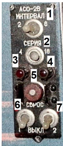
110. számú ábra. 1 db ASzO-2V7201-0 kezelőpult (a szerző felvétele, Kecskemét, 2024.02.21.)
