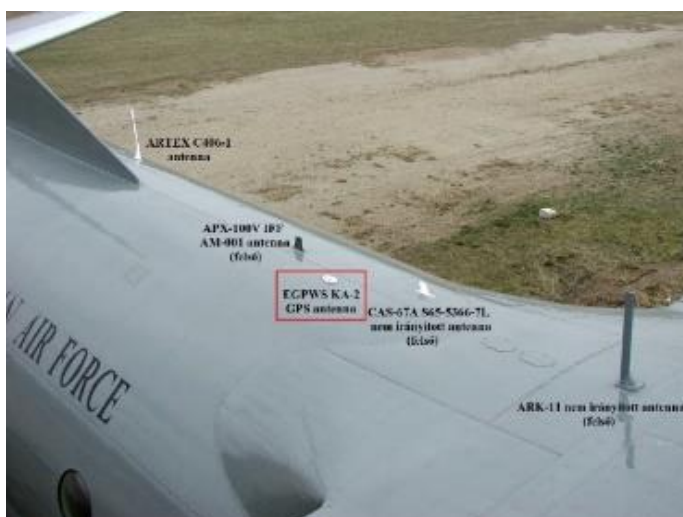
166. számú ábra. Az EGPWS KA-92 típusú GPS-antennája a repülőgéptörzsön, a 25-26. törzskeretek között (piros színnel jelölve) - az MH Lé. Jü. felvétele
