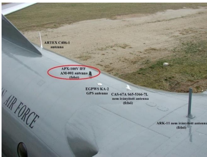
105. számú ábra. Az APX-100V felső AM-001 (vagy AT-741) antenna beépítési helye (piros színnel jelölve) – az MH Lé. Jü. felvétele
