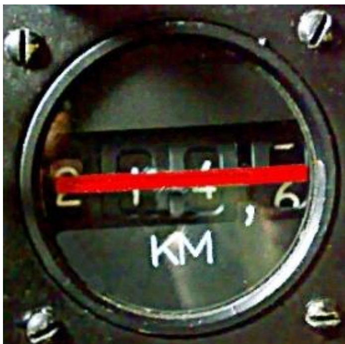
33. számú ábra. Az SzD-67 IDR-1B távolságjelző műszere - forrás 29
