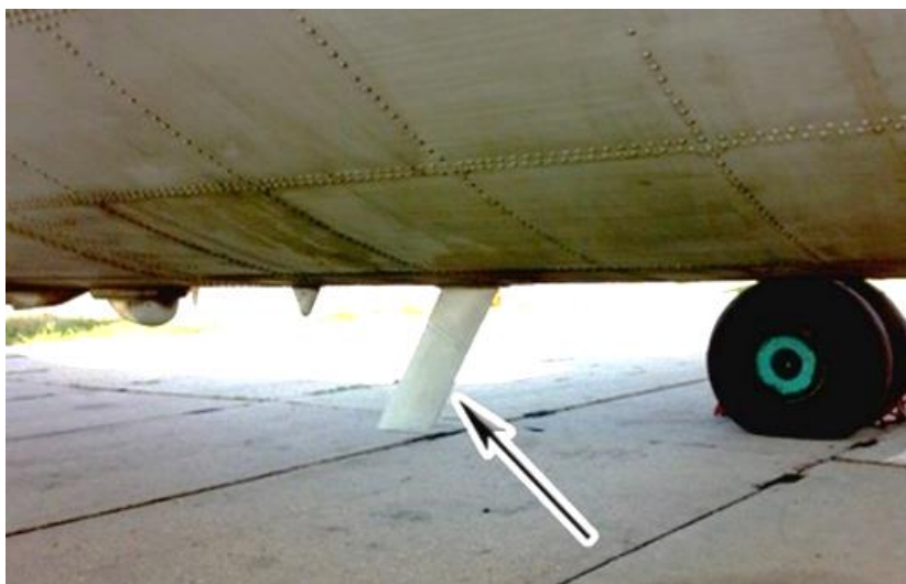
65. számú ábra. A 2. sz. Baklán-20 VHF rádióállomás ASSz-UD antennája a repülőgép törzsének alján, a 19-20. törzskeretek között (az MH Lé. Jü. felvétele)
