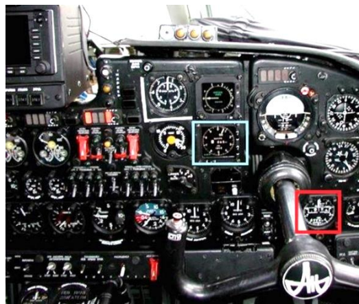
141. számú ábra. A VBE-SzVSz-CM (kék négyszögben) és az UVID-30-15K-2 (piros négyszögben) végleges beépítési helye a II. repülőgépvezető műszerfalán (a szerző felvétele, Kecskemét, 2024.05.03.)
