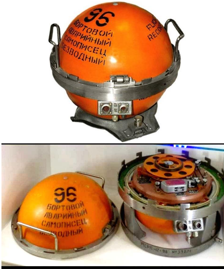
177. számú ábra. Az MSzRP-12-96-1-05 repülésiadat-rögzítő (2. „feketedoboz”) – felül összeszerelt állapotban, alul levett burkolattal (az MH Lé. Jü. felvételei)
