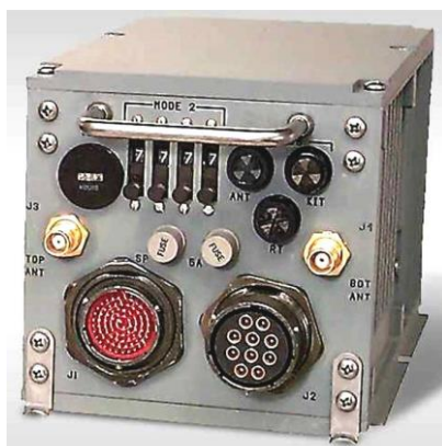
98. számú ábra. Az RT-1157V adó-vevő előlapja - forrás 48
