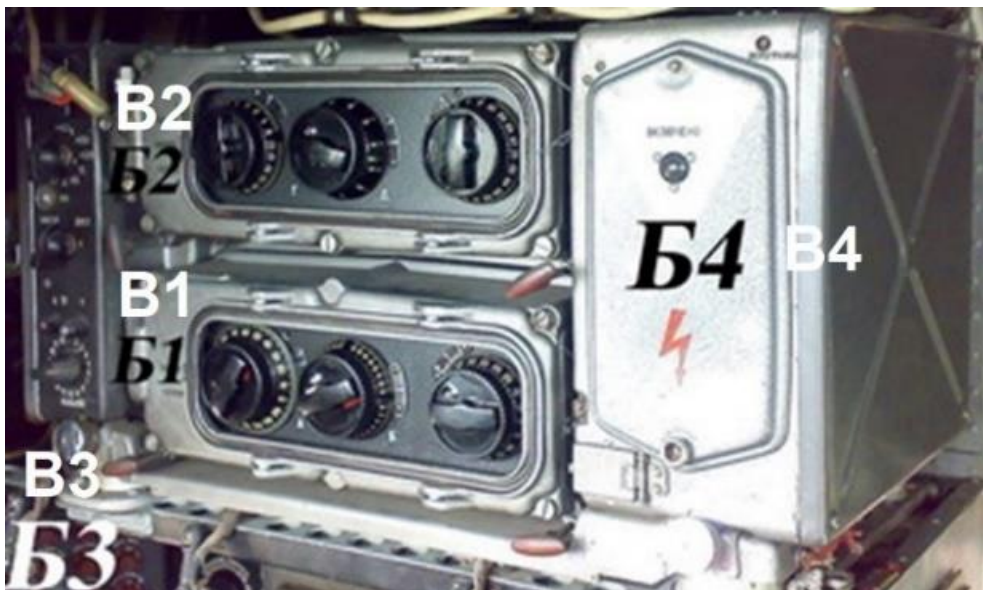
37. számú ábra. Az R-836 RH adó főbb blokkjai: B1 gerjesztő, B2 kimeneti fokozat antennaköre, B3 táplálás, csatlakoztatás és modulálás blokkja, B4 elektroncsövek egysége – forrás 31
