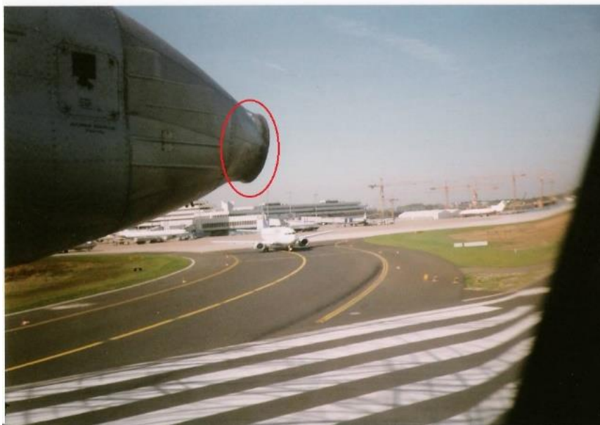
6. számú ábra. Az An-26 repülőgép jobb oldali AI-24VT főhajtóművének gondolája végén látható a RU-19A-300 segédhajtómű gázkiáramló csöve (a szerző felvétele, Ingolstadt, Németország, 1998.04.21.)
