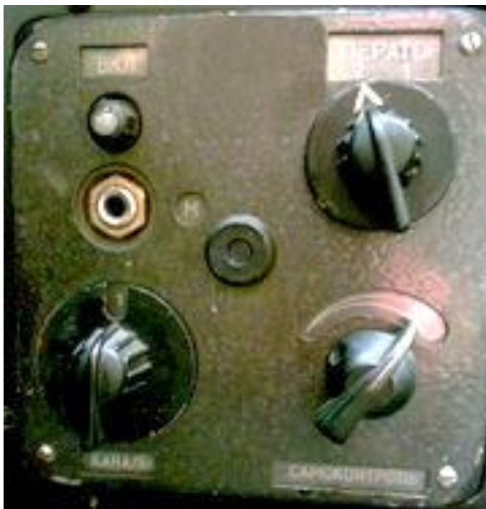
39. számú ábra. A II. repülőgépvezető B7 kezelőpultja – forrás 31
