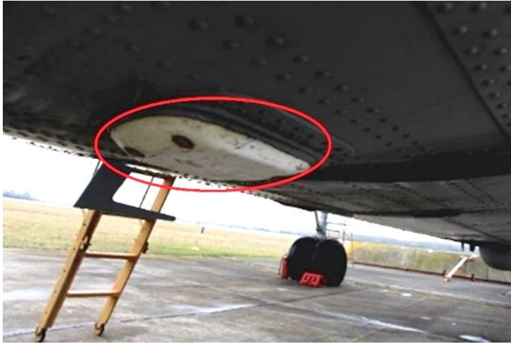
162. számú ábra. A TPU-67A ANT-67A alsó irányított antennája a repülőgéptörzs alján, az 5-6. törzskeretek között (az MH Lé. Jü. felvétele)
