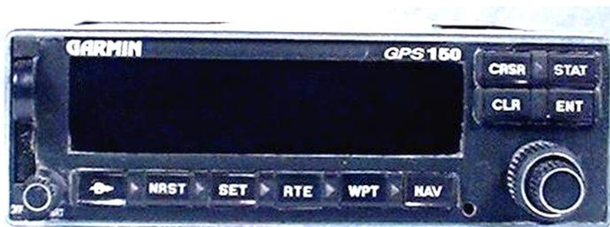
87. számú ábra. A GPS-150 vevő előlapja - forrás 43
