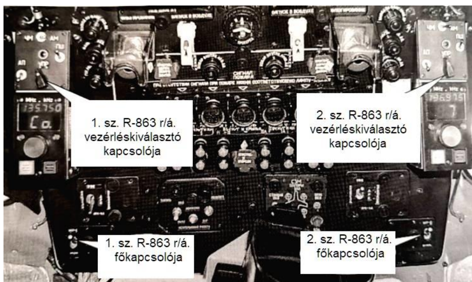
75. számú ábra. Az 1. és 2. sz. R-863M1 VHF-UHF rádióállomás 16b-M kezelőpultjai a repülőgépvezetők felső műszerfalán (csak a 110-es An-26 repülőgépen) – az MH Lé. Jü. felvétele
