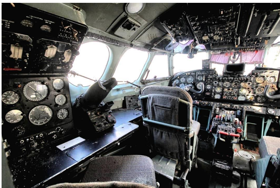
7. számú ábra. Az An-24V repülőgép személyzeti fülkéje. A bal oldali I. repülőgépvezető mögött található a fedélzeti megfigyelő (navigátor) munkahelye - a kép forrása: az egykori Szolnoki Repülőmúzeum archívuma
