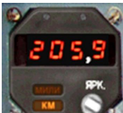
148. számú ábra. ISzD-1 távolságjelző műszer (az MH Lé. Jü. felvétele)
