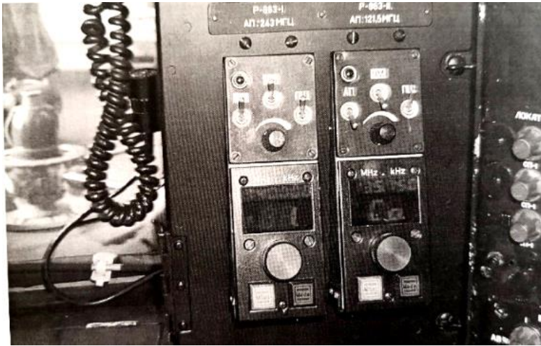
76. számú ábra. Az 1. és 2. sz. R-863M1 VHF-UHF rádióállomás 10V-M1 kezelőpultjai a fedélzeti rádiós műszerfalán (csak a 110-es An-26 repülőgépen) – az MH Lé. Jü. felvétele
