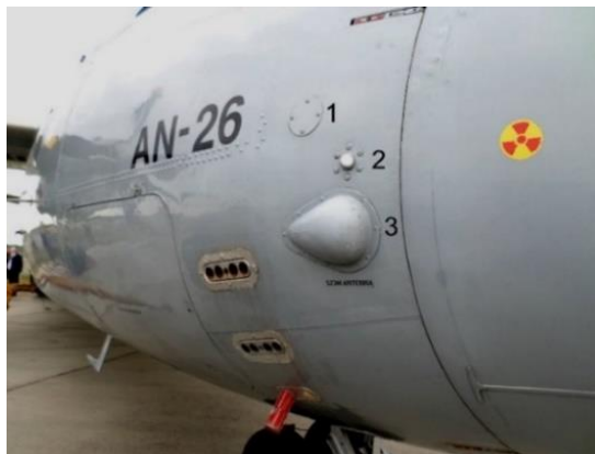
96. számú ábra. Az orrkúp mögötti jobb oldali rész kinézete a modernizálás után (a bal oldalon ugyanezek találhatók) – a szerző felvétele, Kecskemét, 2024.05.03.
