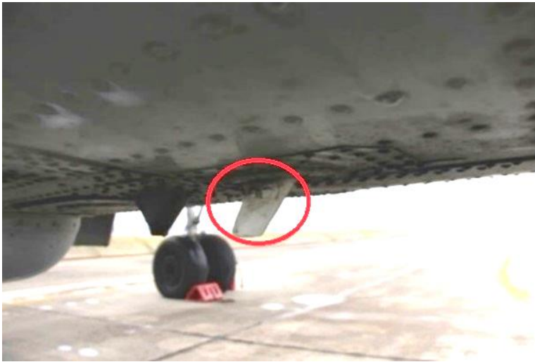
160. számú ábra. Az MST-67A válaszadó ANT L-BAND típusú alsó nem irányított antennája a repülőgéptörzs alján, a 10-11. törzskeretek között (az MH Lé. Jü. felvétele)
