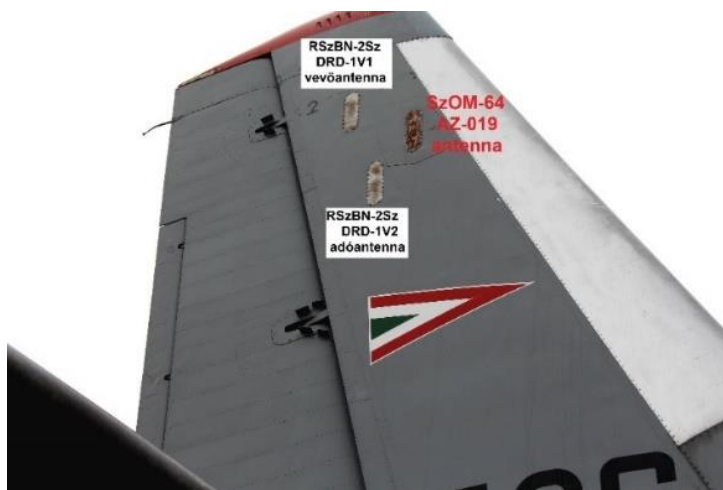
29. számú ábra. A SzOM-64 válaszadó AZ-019 antennája a függőleges vezérsík felső részén, az RSzBN-2Sz antennák előtt (az MH Lé. Jü. felvétele)
