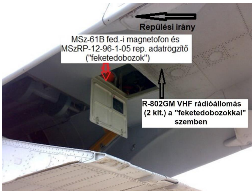
60. számú ábra. A 2 klt. R-802GM rádióállomás beépítési helye a kissé lenyitott helyzetű rámpa felett, a 40-43. törzskeretek között – forrás 34
