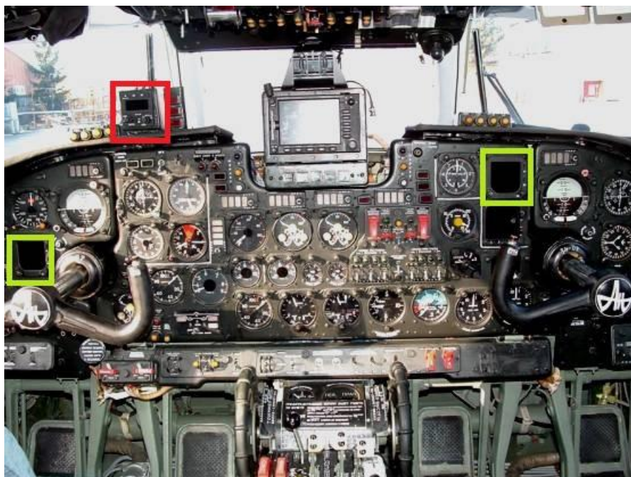
156. számú ábra. A PS-578A vezérlőpult (piros színnel jelölve) és az IVA-81D jelzőműszerek (zöld színnel jelölve) elhelyezése az An-26 személyzeti fülkében (az MH Lé. Jü. felvétele)
