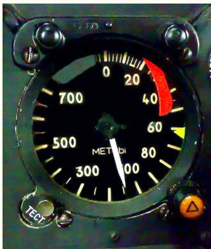
116. számú ábra. Az RV-4 rádió-magasságmérő UV-4A jelzőműszere (az I. repülőgépvezető előtti műszerfal bal oldalán - forrás 54 )
