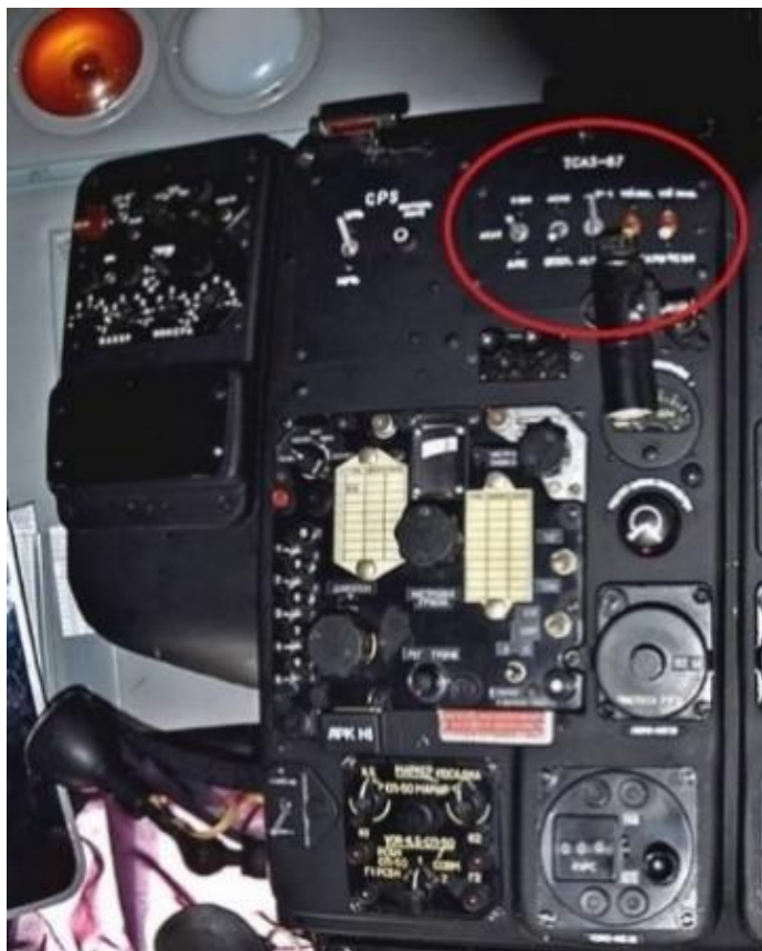
157. számú ábra. A TCAS-67 kapcsolói a repülőgépvezetők középső felső műszerfalán (piros színnel jelölve) – a szerző felvétele, Kecskemét, 2024.05.03.
