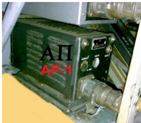
45. számú ábra. Az AP-1 amplitúdó-előtét beépítési helye a II. repülőgépvezető ülése alatt- forrás 32
