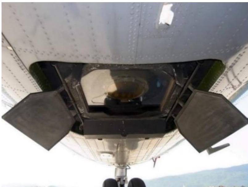
17. számú ábra. Légifényképezőgép egyes magyar An-26 típusú repülőgép alsó vészkijáratába beépítve; a védőzsakuk nyitott helyzetben vannak (az MH Lé. Jü. felvétele)
