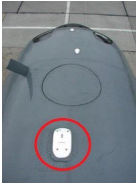
161. számú ábra. A TPU-67A ANT-67A felső irányított antennája a repülőgéptörzsön, a 7-8. törzskeretek között (az MH Lé. Jü. felvétele)
