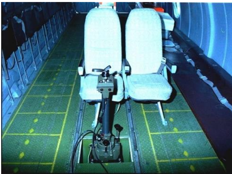
19. számú ábra. A földfelszín vizsgálatához beépített távcső az An-26 teherterében (az MH Lé. Jü. felvétele)
