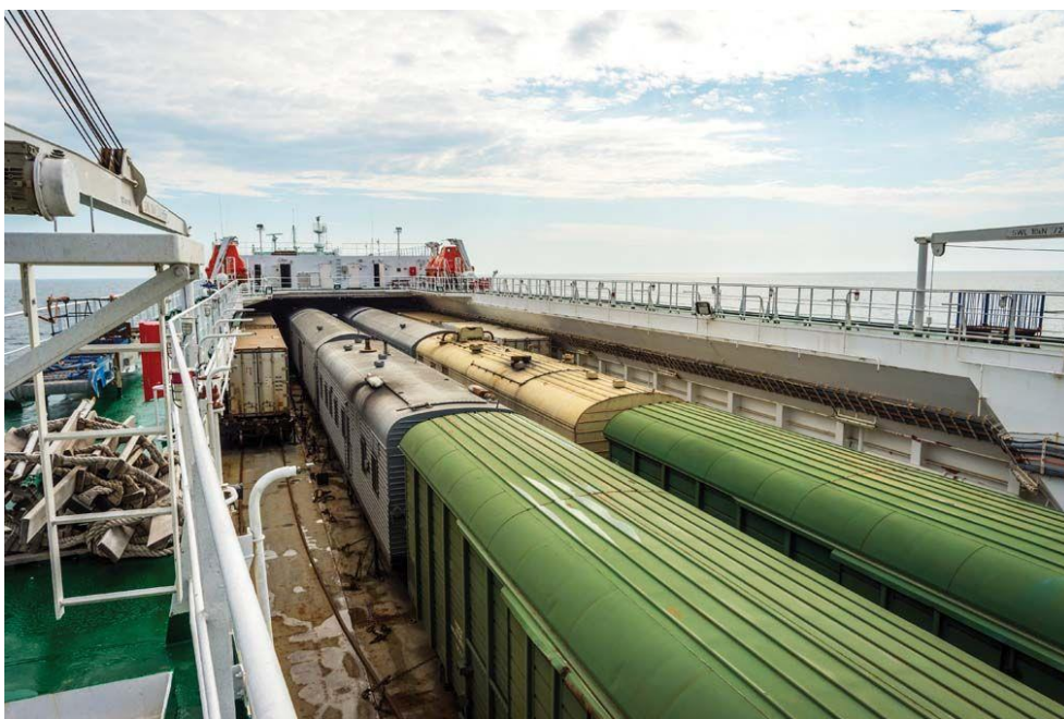
6. számú ábra. RO-RO hajózási technológia alkalmazása a Kaszpi-tengeren, ami egyfelől lassítja a vasúti szállítást, másfelől veszélyes és időjárásfüggő megoldás 26
