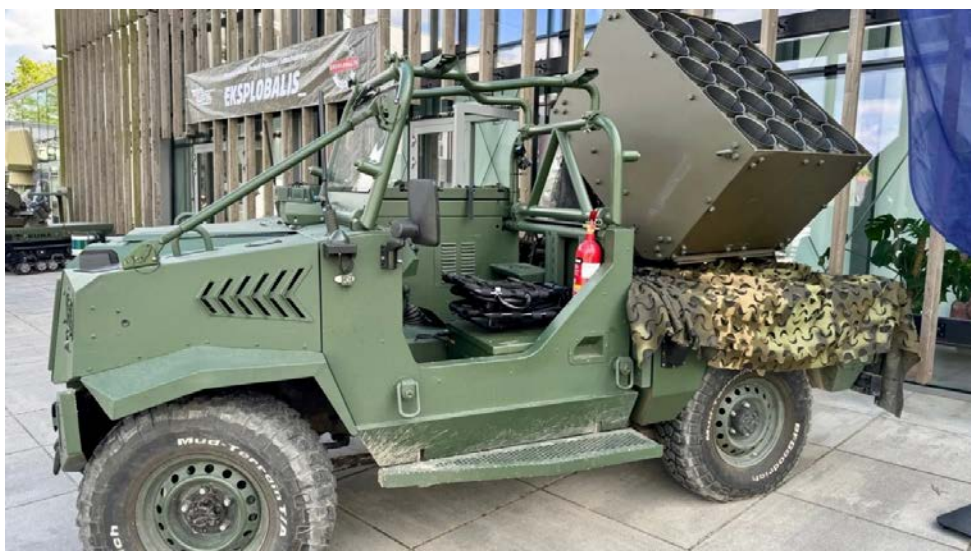
11. számú ábra. Lengyel Bluszcz kettős rendeltetésű aknaszóró jármű 43
