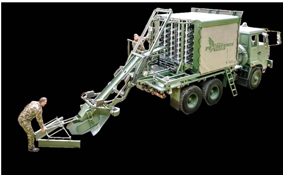
3. számú ábra: Lengyel ZUMP aknatelepítő műszaki jármű 21
