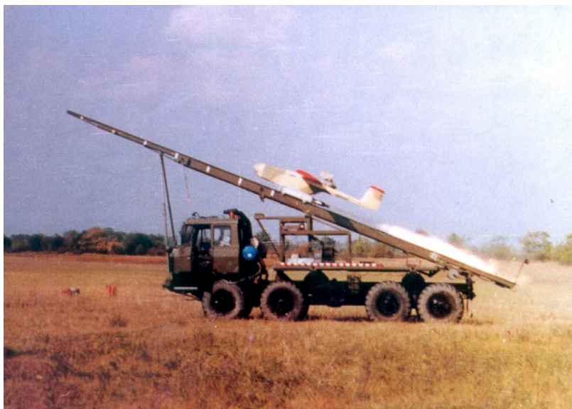
4. számú ábra. A Szojka UAV korai változata a segédrakétás indítás során 12 méteren éri el a 130 km/h-s startsebességet
