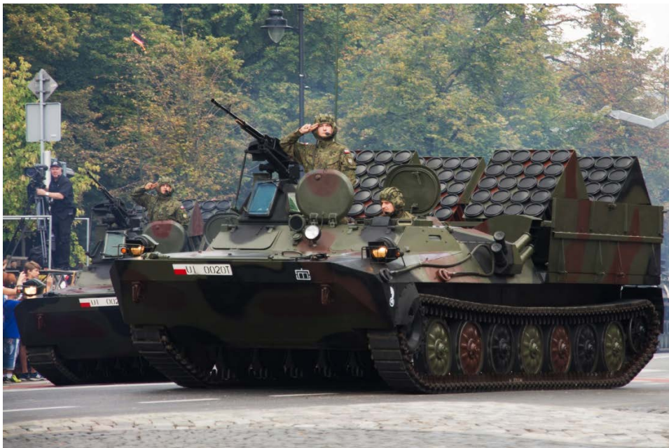
6. számú ábra. KROTON műszaki aknaszóró gép 32
