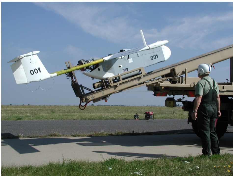
2. számú ábra. Wankel-motoros Szojka-variáns az indítógépkocsi állványán. Jól látható a gyorsítórakéta
