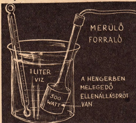
1. ábra. Ha 1 liter vízbe 500 wattos elektromos merülőforralót teszünk, a víz 5 perc alatt 35,8\text{ }^{\circ}\text{C} -kal melegszik fel
