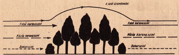
5. ábra. Helyes szerkezetű erdősáv keresztmetszete
