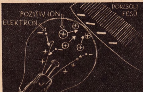
2. ábra. A burában lévő gáz pozitív ionjait a fésű vonzza, a negatívokat taszítja. A gázionok gyorsuló mozgásba jönnek
