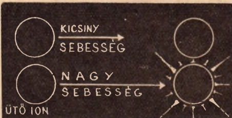
3. ábra. Az ütő gázionnak bizonyos nagyságú sebességet kell elérnie, hogy ütközéskor fénykibocsátásra tudja gerjeszteni a meglökött gázatomot
