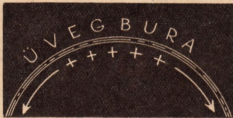
2. ábra. Ha a fésűt eltávolítjuk, a bura belső felületére rakódott pozitív gázionok töltését elvezeti az üveg felülete
