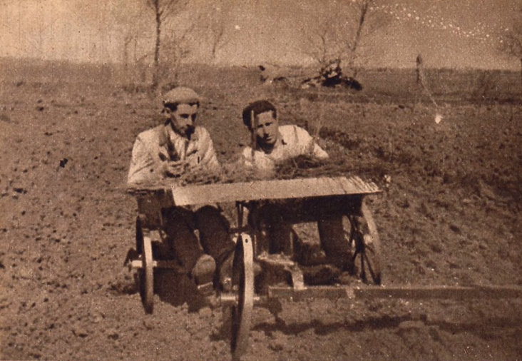
Hansági csemeteültető-gép. Balsay László erdőmérnök újítása
