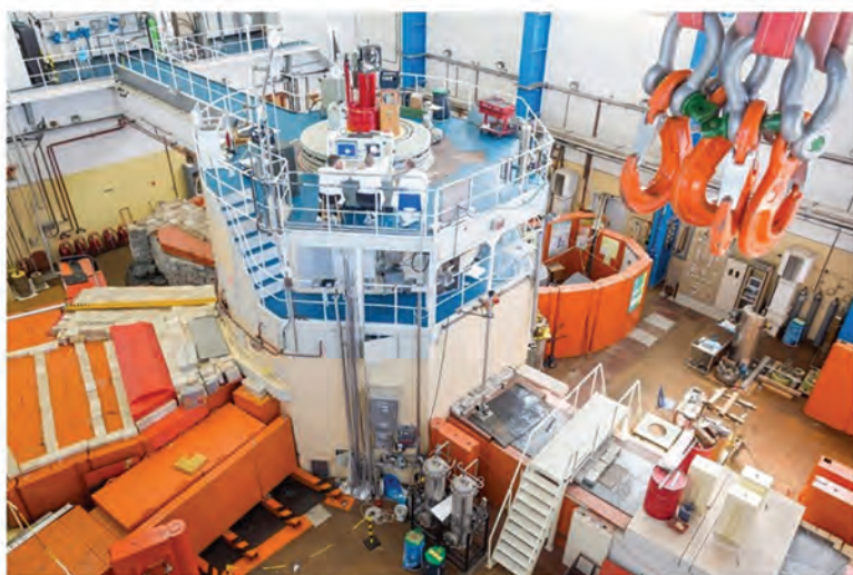
Szolgáltatásként az egészségügyben és az iparban használható radioaktív izotópok előállítására, szerkezeti anyag besugárással, anyagvizsgálatok
