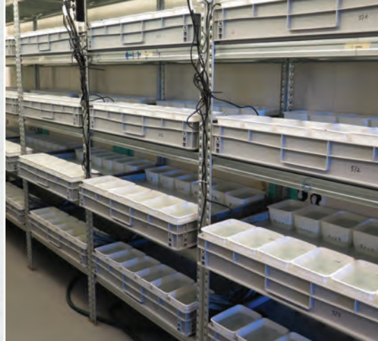
A vizsgálatban részt vevő ebihalak fertőzés utáni hőkezelésére szolgáló berendezés. Az ebihalakat 2 literes tartódobozokkal együtt nagy műanyag tálcákba helyeztük, amelyek a külső fűtőközeg keringetését szolgáló szivattyút és egy fűtőszálat tartalmazzak. A fűtőszálat úgy állítottuk be, hogy a kezeléstől függően 22, 28 illetve 30 Celsius-fokra melegítsék fel az ebihalak tartóvizét. (FOTÓ: KÁSLER ANDREA)
