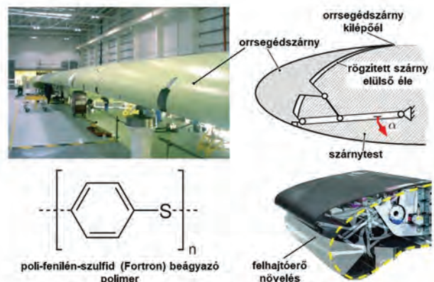
A szárny belépőél (orrsegéd szárny) kialakítása, működése
