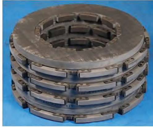
Szén-szén kompozittárcsák a repülőgép kerékfékjében
