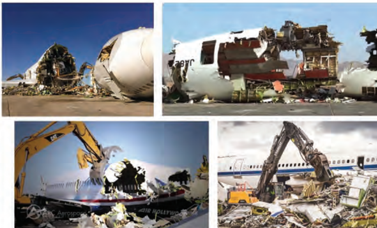
A forgalomból kivont repülőgép kompozitszerkezetei újrahasznosítás hiányában a lerakóba kerülnek
