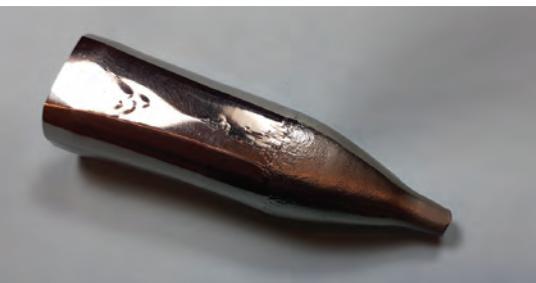
Indium-antimonid (InSb), kristályhúzásos (Czochralski-) módszerrel növesztett egykristálya
