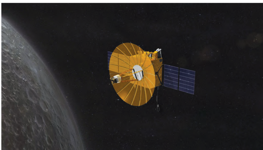
A Csüecsiao-2 kínai átjáróhold. Parabolaantennájának átmérője 4,2 m. A holdfelszíni eszközökkel az X és UHF, míg a Földdel a Ka- és S-sávokban kommunikál.
