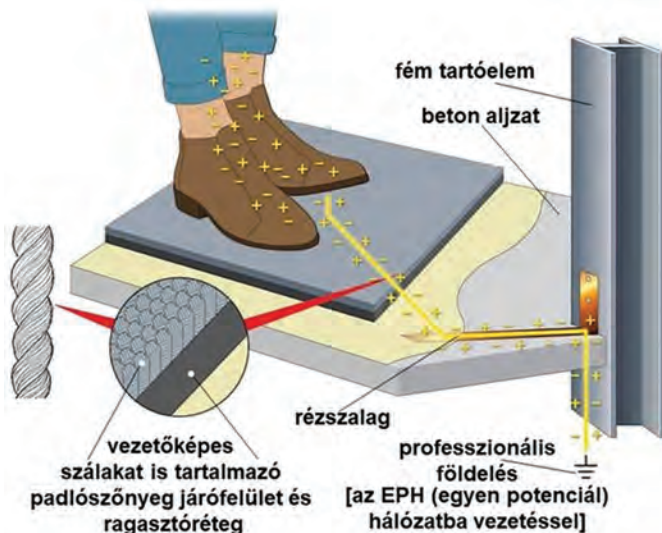
Padlószőnyeg földelésére példa
