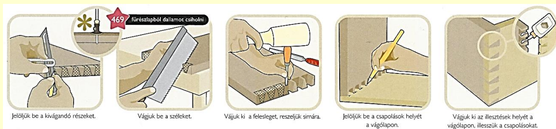
1. ábra: Fecskefarkú fogazás készítésének ábrázolása
