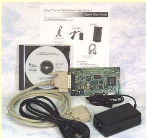
3. és 4. ábra eZdsp F2812-es fejlesztőeszköz és fejlesztőkártya
