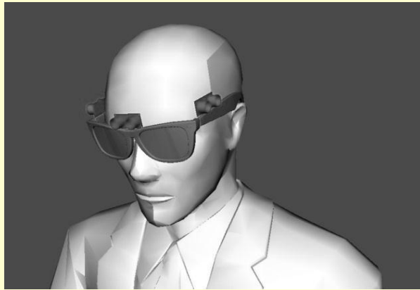
5. ábra A szemüvegen elhelyezett távolságérzékelő szenzorok
