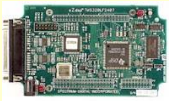
3. és 4. ábra eZdsp F2812-es fejlesztőeszköz és fejlesztőkártya
