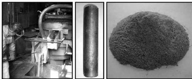
Balra: csapolás 27 az elektromos ívkemencénél, Középen: tömb 28 Co-Ni-Mn-ötvözet, Jobbra: Li-ban gazdag szálló por (pernye).
