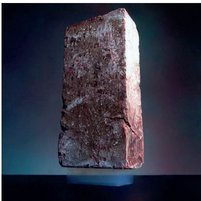
3. ábra. Építési (2,5 kg-os) téglát megtartó 0,2 g-nyi aerogél [7]
