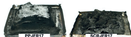
4. ábra. 17% IFR-t tartalmazó egyszerű PP keverék és önerősített kompozit égési maradékai
