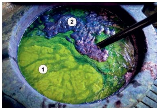
1 \rightarrow csávázott (vízben oldódó) módosulat 2 \rightarrow levegőn visszaoxidálódott módosulat
