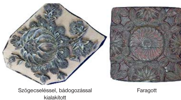
Példák a magas nyomószerszámok (módliek) kialakítására
