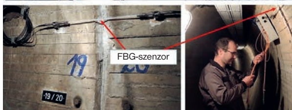
9. ábra. FBG-érzékelővel monitorozott gát Ausztriában
