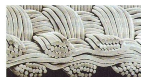
78 dtexes filamentfonalak, 23 db filamentág, 3,4 dtex/filament
